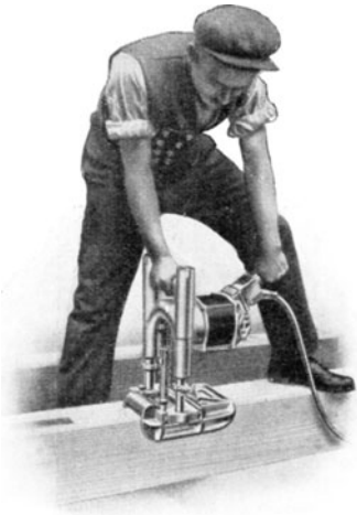
Abb. 47. Elektrischer Handketten-Stemmapparat, zum Zapfenlochstemmen eingerichtet. Fräskette mit unten runder Führung. Gebr. Schmaltz, Offenbach a. M.
