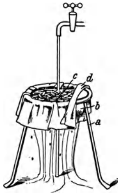
Fig. 14. a Dreifuß. b Sieb. c Hülsen. d Filtriertuch.
