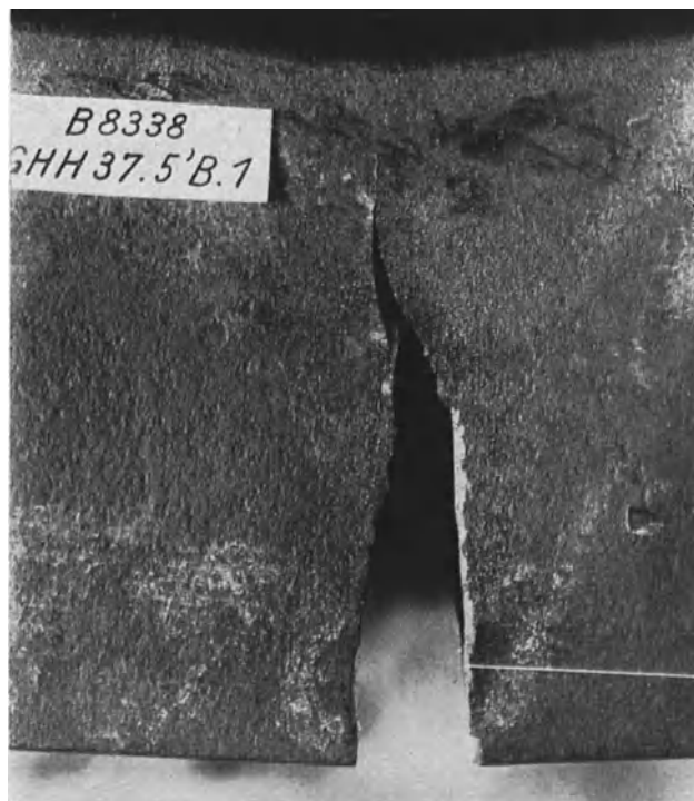
Abb. 27. Bruchstelle in der Zugzone des Trägers 5' B. 1 der Reihe 5'b; Seitenflächen des Flansches an der Bruchstelle geschlichtet.
