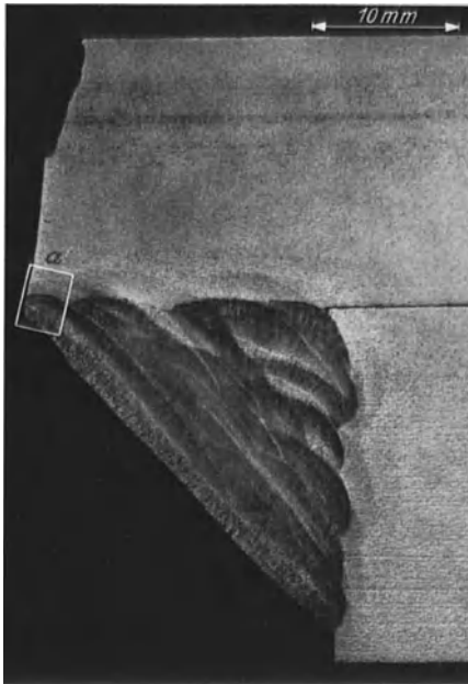
Abb. 41. Schnitt durch die Stirnkehlnaht der Verstärkung des Zuggurts des Trägers 5.4 der Reihe 5. Stirnkehlnaht nach Abb. 34; a = 15,5 \text{ mm} ; \alpha_A = 45^\circ . Links oben liegt die Bruchstelle des Zuggurts des Trägers. Die nachträglich aufgebraachte letzte Lage unterscheidet sich durch ihr Gefüge von den darunter liegenden Lagen.
