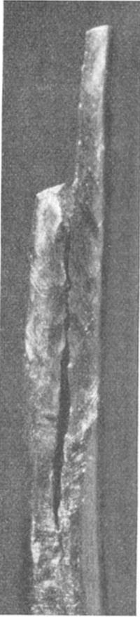
Abb. 21. Ein Draht, aus zwei längs zusammengewachsenen *Bz*-Kristallen bestehend, wurde gereckt und gerissen. Das Bild zeigt ein Bruchstück. Entgegengesetzt verlaufende Gleitlinien. Aufreißen der Korngrenze längs des Drahtes als Folge der Spannungen entlang derselben.
