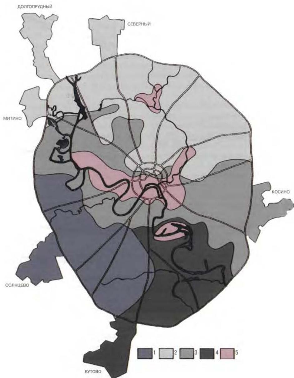
Рис 5 7 Карта типов строения геологической среды для проектирования строительства линий метрополитена глубокого заложения. Условные обозначения при проложении трассы: 1 – в юрских глинах, 2 – в перхуровских и ратмировских известняках верхнего карбона, 3 – в суворовских известняках верхнего карбона, 4 – в подольско-мячковских известняках среднего карбона, 5 – в верхнекаменноугольных известняках, непосредственно залегающих под четвертичными отложениями
