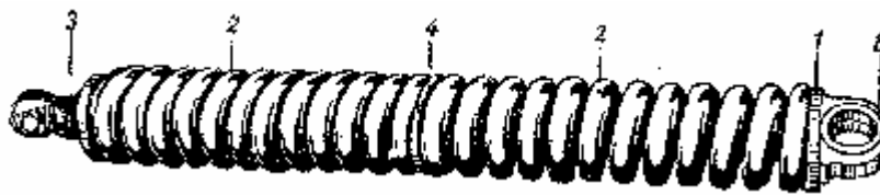
Рис. 140. Общий вид подвески 2, 3, 4 и 5-го опорных катков 1 — шток с проушиной; 2 — пружина; 3 — регулировочный стакан; 4 — направляющая втулка, 5 — втулка проушины
