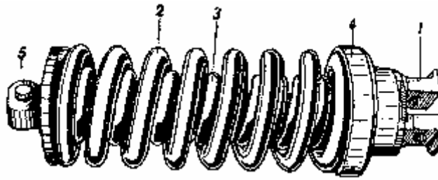
Рис. 138. Общий вид передней подвески в сборе; 1 — шток с проушиной; 2 — наружная пружина; 3 — внутренняя пружина; 4 — опора наружной пружины; 5 — регулировочный стакан.
