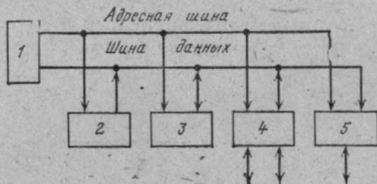
Рис. 6.12. Упрощенная структурная схема микро-ЭВМ
