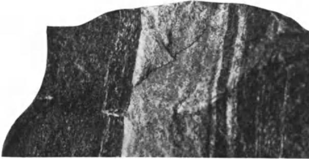
Abb. 3. Lagentracht. Bänderamphibolit aus dem Mölltale (Kärnten); geeignet für Bruchsteinmauerwerk und Packlage, minder gut als Schotter.
