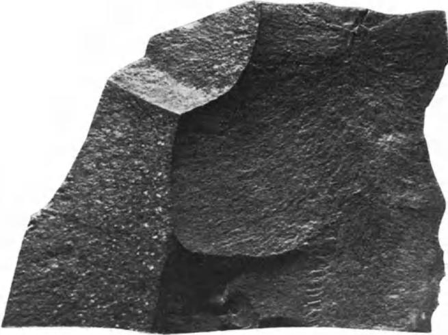
Abb. 10. Flachmuscheliger Bruch. Flyschmergel aus dem Gspöttgraben, Wien.
