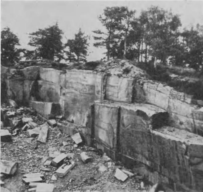
Abb. 23. Klüftung von Granit. Bruch Brohnbühl von Widys Söhne; Schrems, N. Ö.
