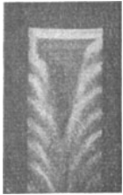
Abb. 593. Elektrischer Funke, im rapid rotierenden Spiegel gesehen. (Zu beachten: Einer hellen Stelle am linken Rande liegt gegenüber eine dunkle am rechten und vice versa.)
