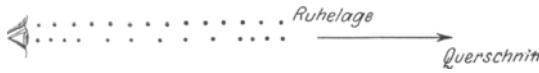
Abb. 290. Oben: Ruhelage einer Punktreihe. Darunter: Dieselben Punkte in einer Phase der Longitudinalwellenbewegung. Daneben: Querprojektion.
