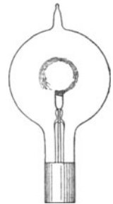
Abb. 518. Kathodenstrahlen im Magnetfeld.
