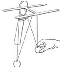
Abb. 44b. Beim elastischen Stoß tauschen einander stoßende gleich große Massen ihre Geschwindigkeit aus.
