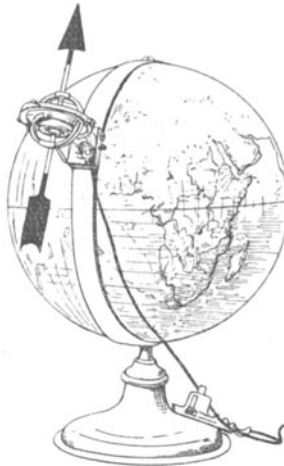
Abb. 137. Zum Kreiselmkompaß. Die Figurenachse des rotierenden Kreisels auf dem Meridian stellt sich infolge der Achsendrehung der Erde in die Ebene des Meridians.
