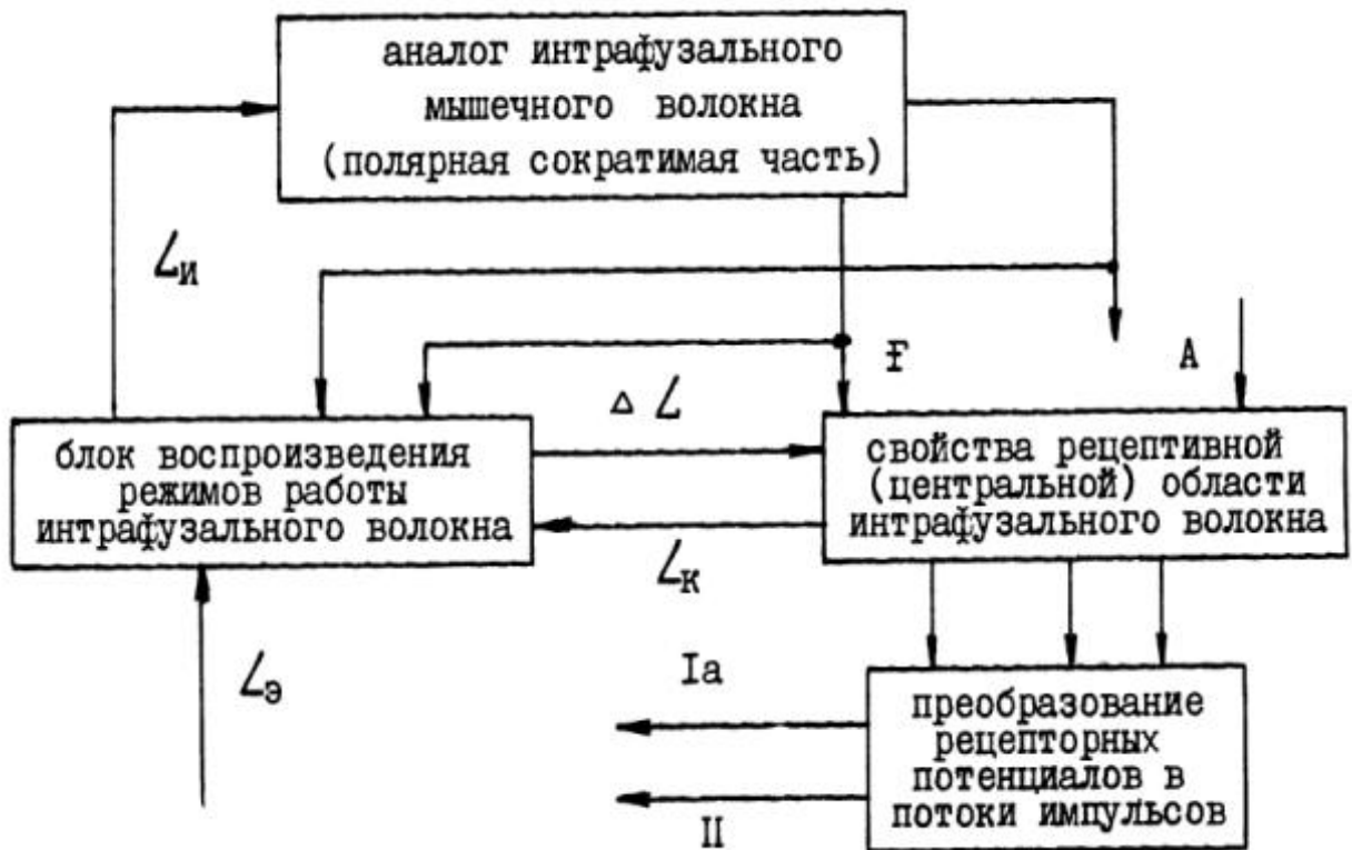
Рис.3.14. Блок-схема преобразования сигналов в электронном аналоге мышечного веретена.
