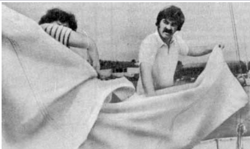
Переднюю шкаторину паруса оставляют прикрепленной к мачте. Два члена команды укладывают большую часть паруса в карман, образованный нижней частью паруса.
