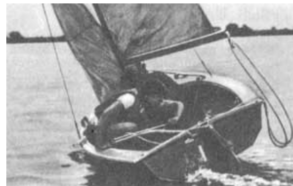
Экипаж швертбота неправильно выполняет поворот фордевинд. Лодка не уравновешена и идет с креном.
