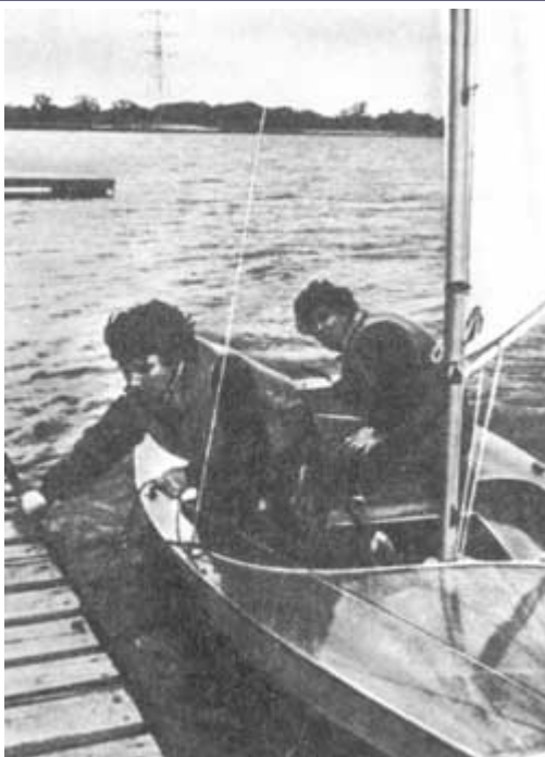
Подход бортом к бону. Матрос держится рукой за край бона и готовится выпрыгнуть из швертбота. Рулевой откренивает лодку.
