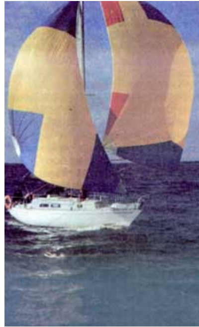
Крейсерско-гоночная яхта несет грот, спинакер и блупер - специальный парус, уравнивающий спинакер.
