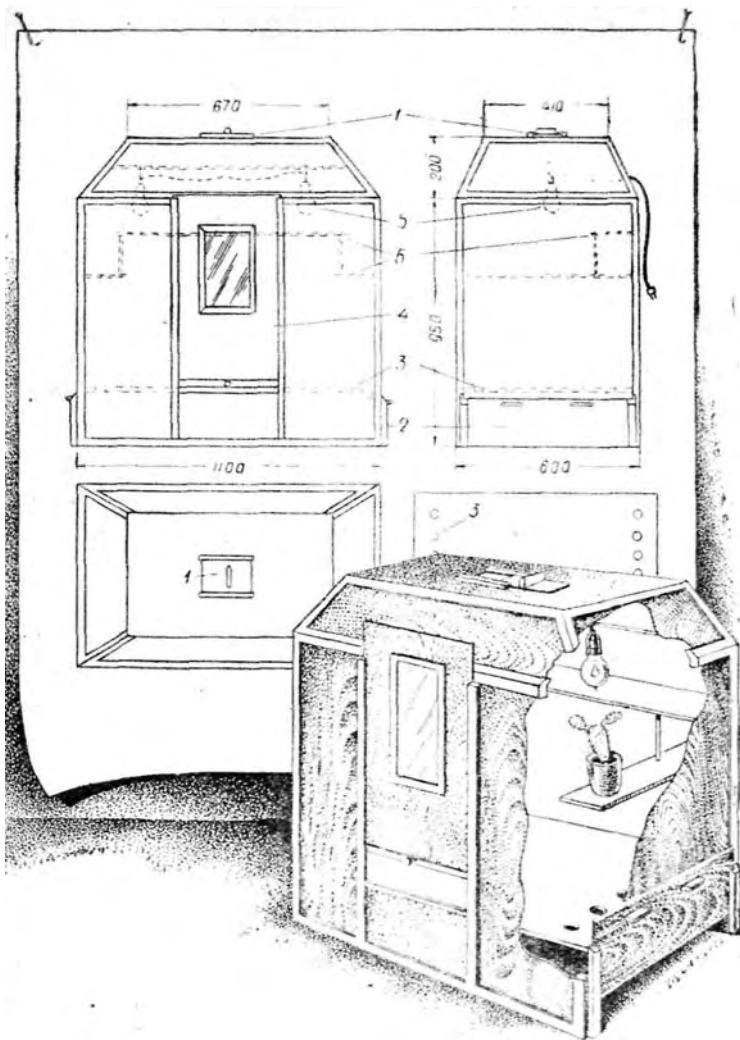
Электрокамера Н. М. Верзилина и ее чертёж с указанием размеров в миллиметрах:
