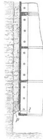
Abb. 207. Offenlassen eines Gußloches unter der Spaltverkeilung bei hängenden Gußringen.
