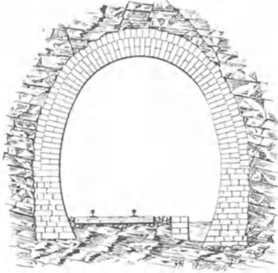
Abb. 113. Elliptisches Gewölbe auf geböschten Scheibenmauern.
