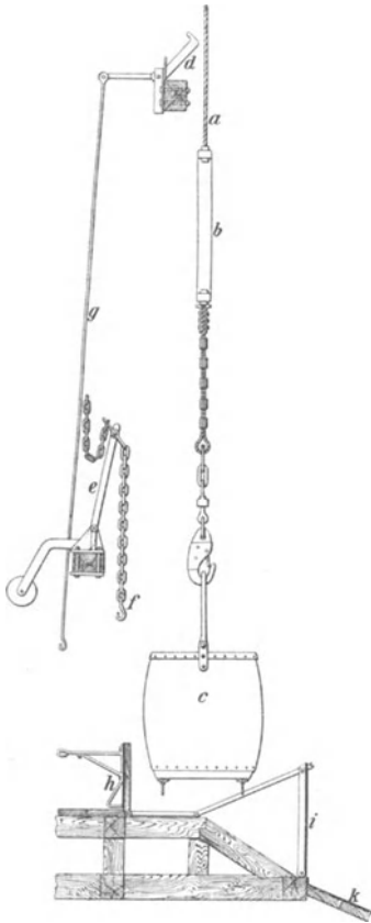
Abb. 231. Kübelkippvorrichtung: Kübel am Seile hängend.
