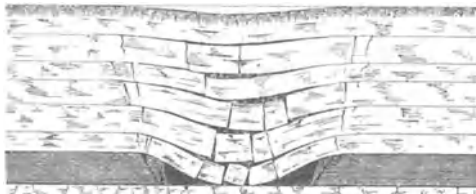
Abb. 3. Verhalten des Tonschiefers über Hohlräumen.
