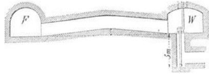
Abb. 640. Sattelförmige Erhebung der Sohle zwischen Förderstrecke und Pumpenkammer.
