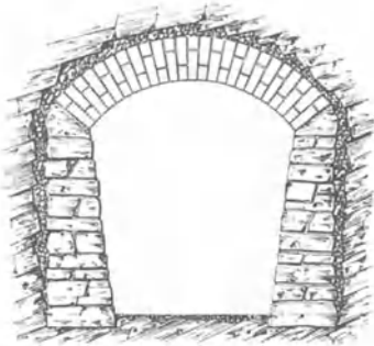
Abb. 107. Geböschte Scheibenmauern aus Bruchsteinen mit Ziegel-Gewölbekappen.
