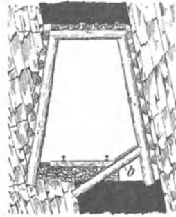
Abb. 33. Türstock mit abgedeckter Wasserseige.
