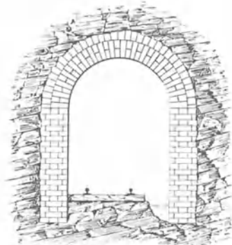
Abb. 108. Scheibenmauern (1 1/2 Stein stark) mit Halbkreisgewölbe.
