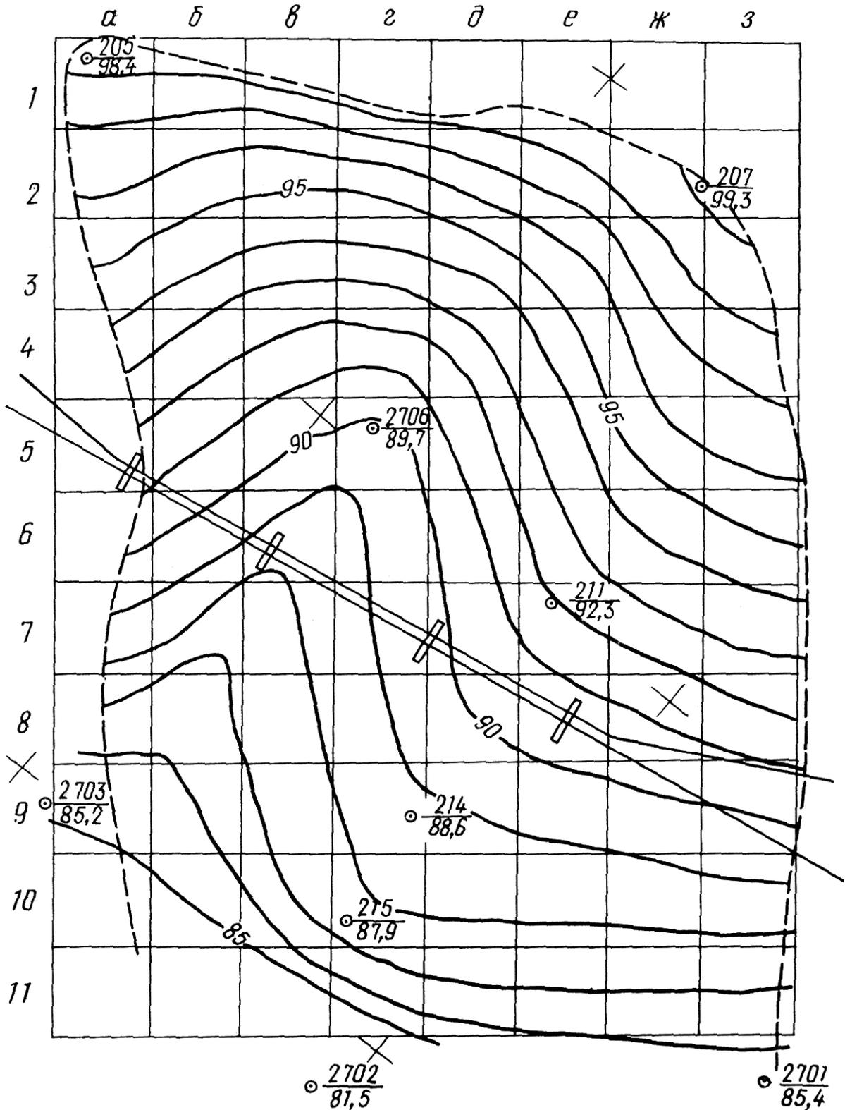
Рис.31. Изолинии поверхности скольжения оползня
