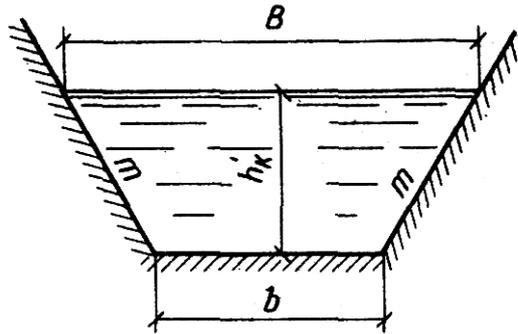
Рис.61. К определению поперечного сечения канав
