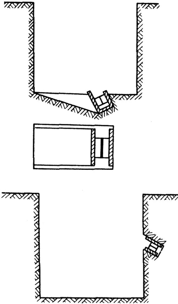
Рис.19. Схема натуральных сдвиговых испытаний грунтов
