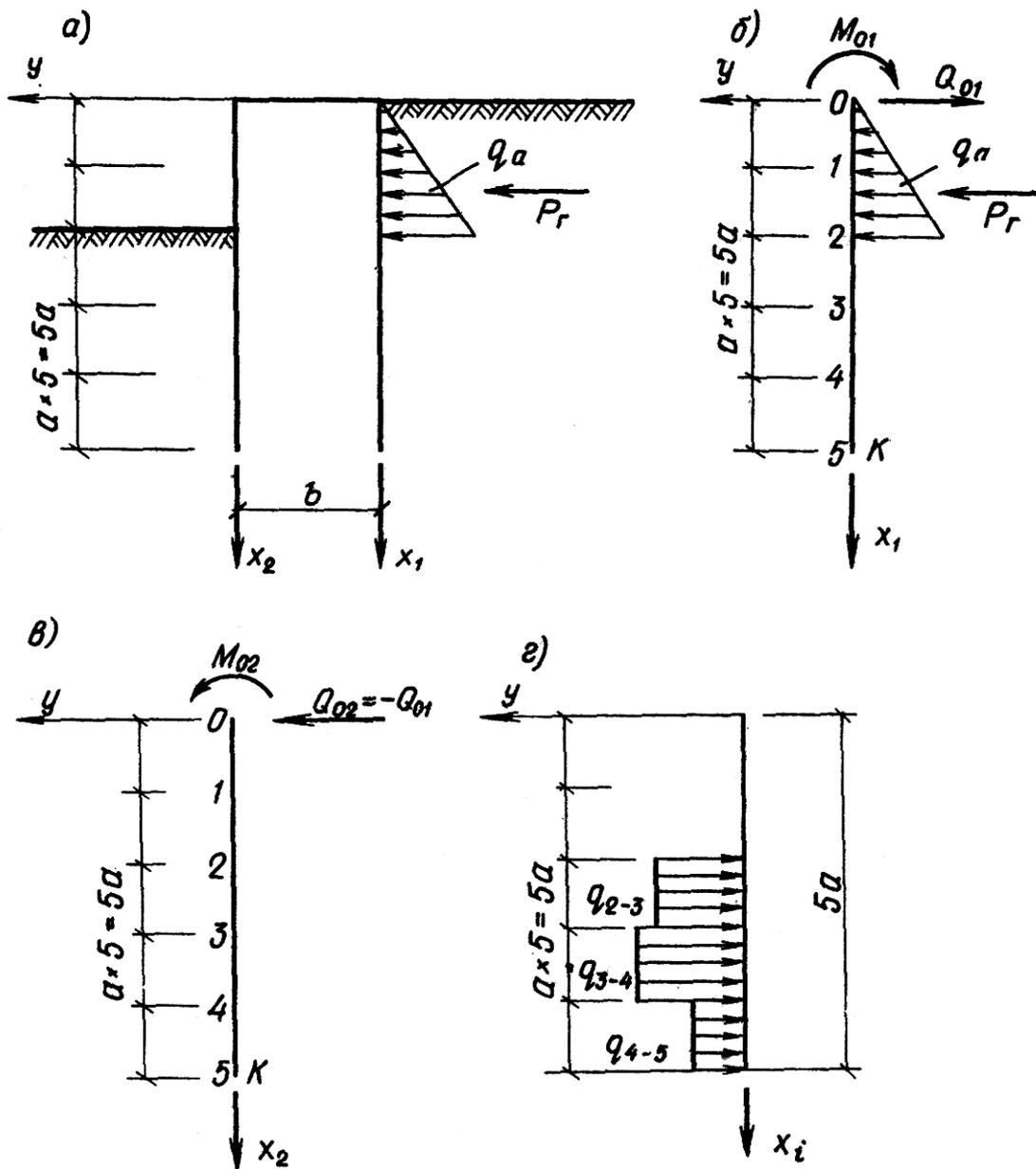
Рис. 67. Подпорное сооружение из буронабивных свай
