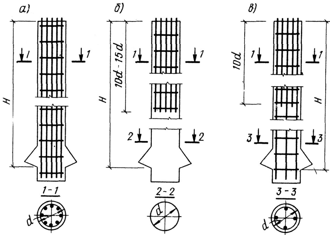
Рис.17. Бутонабивные сваи с равномерно распределенным армированием
