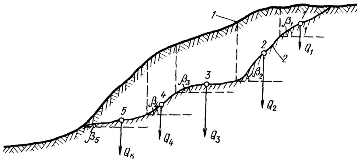
Рис.26. Схема к расчету оползневому давлению по методу Шахунянца:
