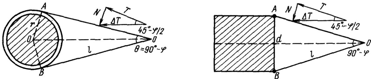
Рис.45. Схема обтекания оползнем одиночной свайной опоры
