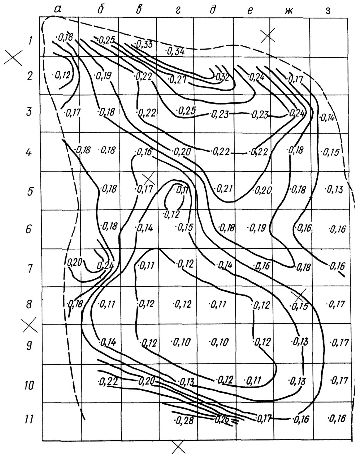
Рис.33. План изоуклонов поверхности скольжения оползня
