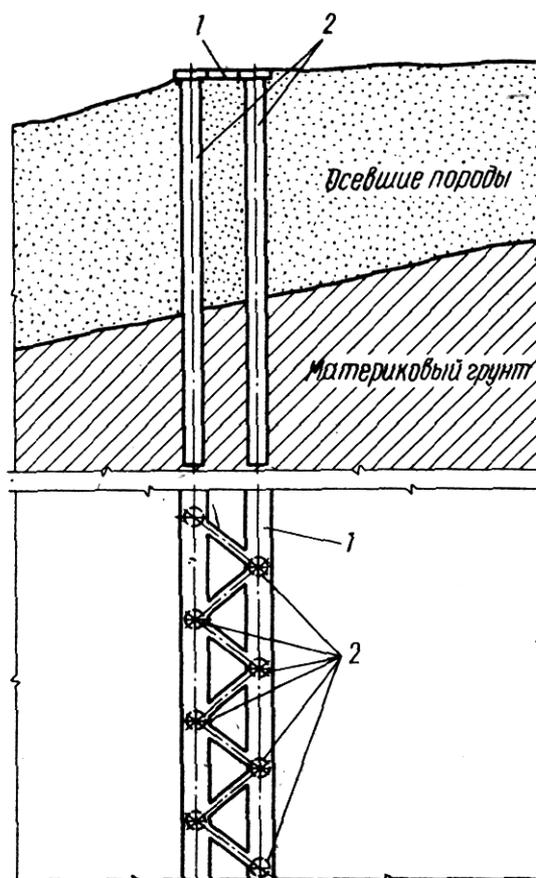
Рис.8. Двухрядное свайное ограждение, объединенное общим ростверком в виде фермы
