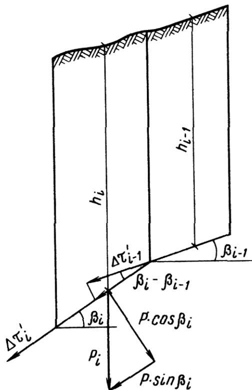
Рис.35. Схема к расчету оползневого давления с учетом реактивных сил соседних призм
