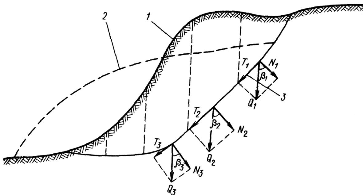
Рис.21. Схема к определению сдвиговых характеристик грунтов по съемке обрушений
