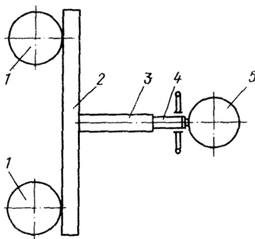
Рис. 78. Схема испытания сваи с упором в две соседние
