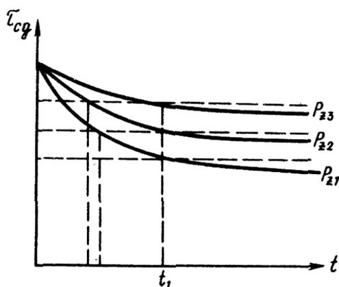
Рис.24. Кривые длительной прочности грунта (по второму методу)
