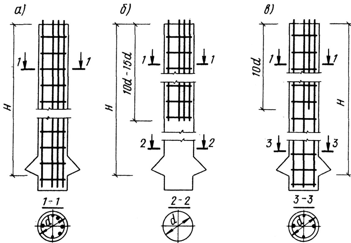
Рис.18. Бутонабивные сваи с сосредоточенным несимметричным армированием
