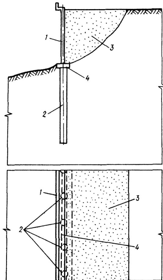
Рис.2. Подпорные стенки, возводимые на однорядных буронабивных сваях, объединенных ростверком
