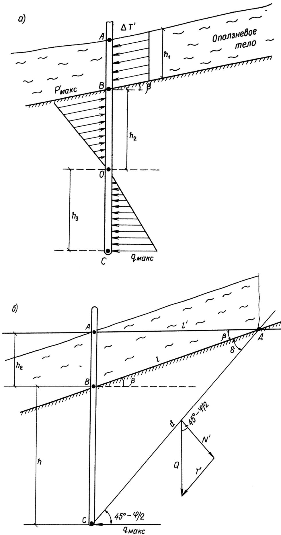
Рис.46. Схема к расчету величины заглубления свайных опор в неподвижный подстилающий оползень грунт
