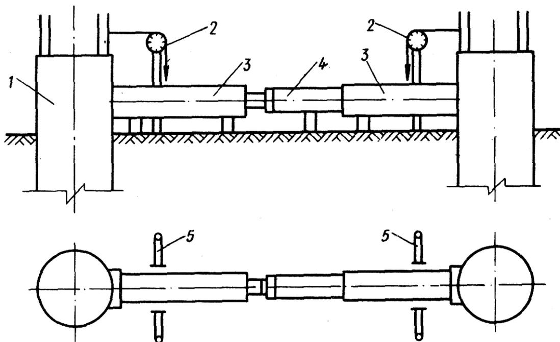
Рис. 76. Схема одновременного испытания двух свай
