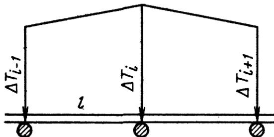
Рис.52. Схема к определению величины оползневое давления, воспринимаемого каждой упорной стойкой
