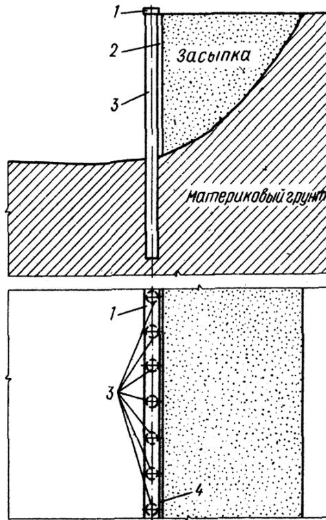
Рис.1. Однорядные подпорные стенки с буронабивными сваями, объединенными ростверком
