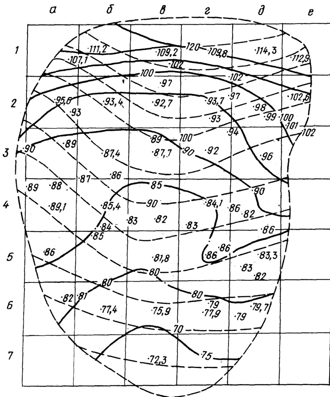
Рис. 55. Горизонталы топоповерхности и изолинии проектной поверхности оползня
