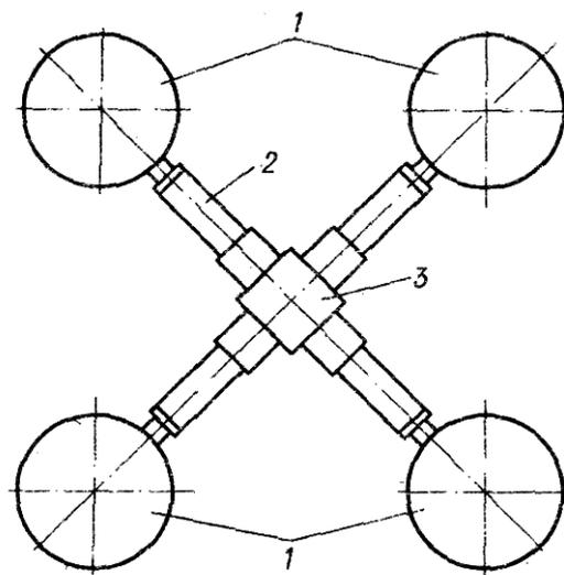
Рис. 77. Схема одновременного испытания четырех свай
