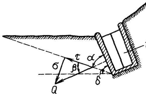
Рис.20. Схема к определению сдвиговых характеристик грунтов по натурным испытаниям
