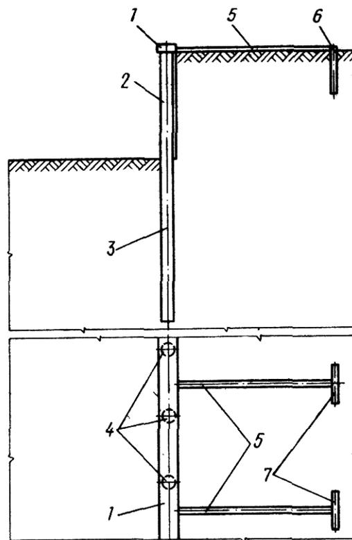
Рис.6. Однорядные подпорные стенки с буронабивными сваями с ростверками и анкерами
