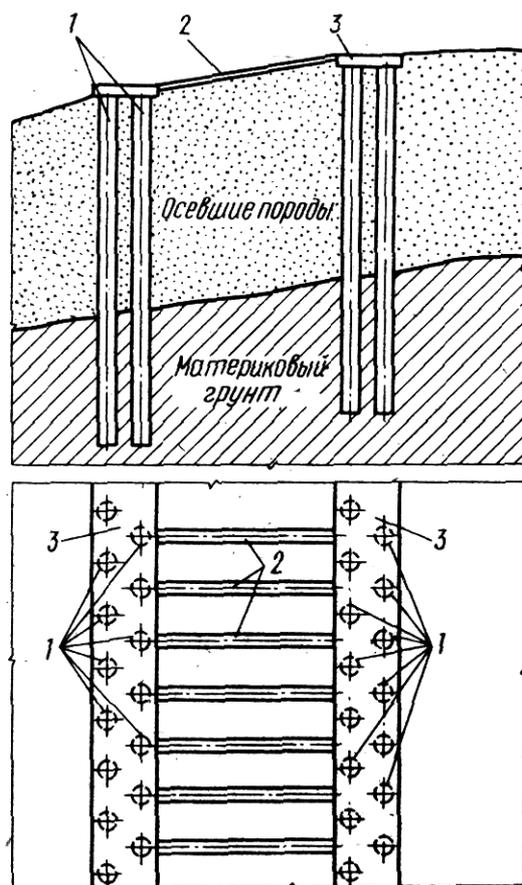
Рис.9. Двухъярусное свайное ограждение из двухрядных буронабивных свай, объединенных ростверками и анкерами
