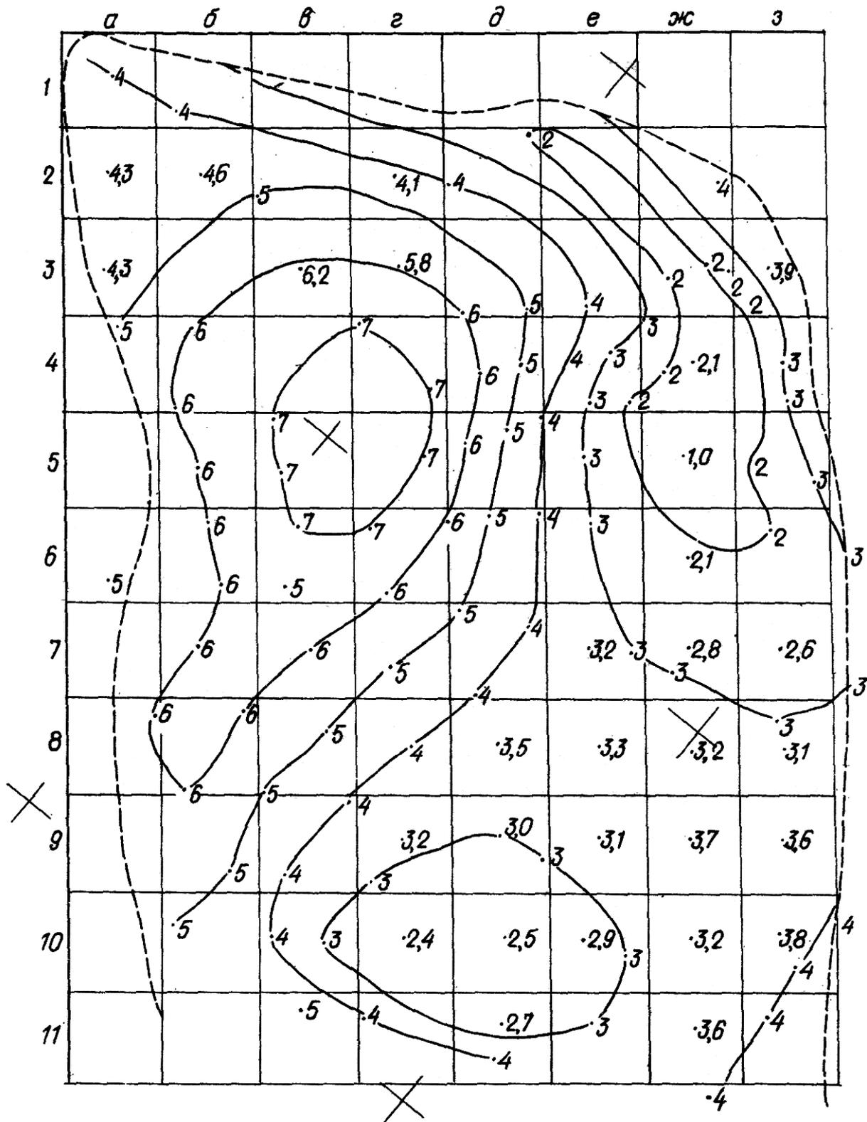
Рис.40. Изомощности затопленной части оползневого тела
