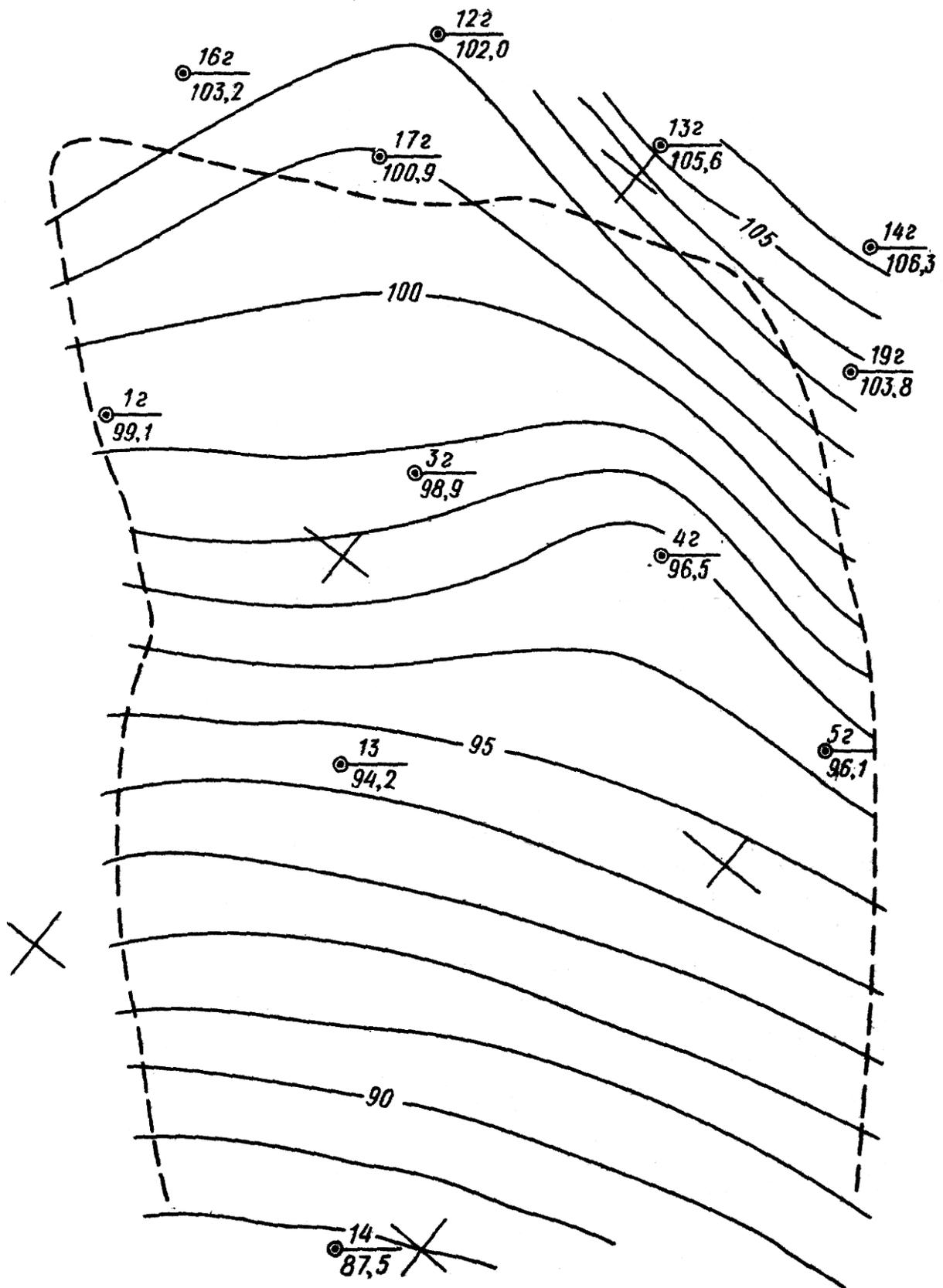
Рис.39. Изолинии депрессионной поверхности уровня грунтовых вод
