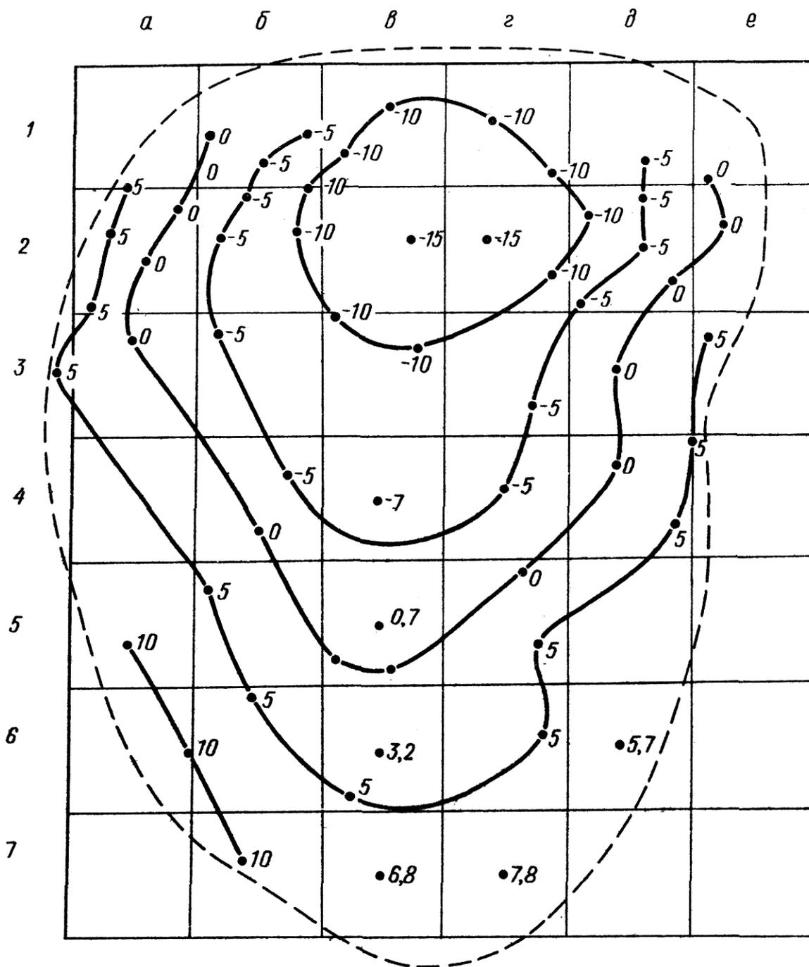
Рис.56. Изолинии рабочих отметок при вертикальной планировке поверхности оползня под устойчивую проектную поверхность
