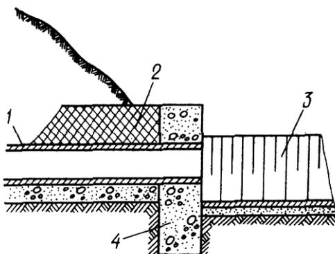
Рис. 65. Оголовки дрен портального типа
