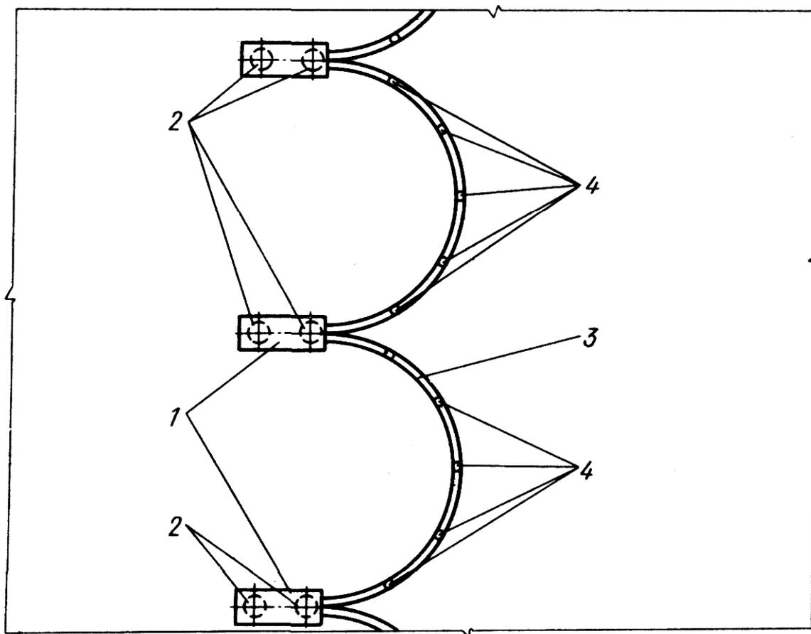
Рис.13. Удерживающие противооползневые сооружения из буронабивных свай с арочным заполнением между ними
