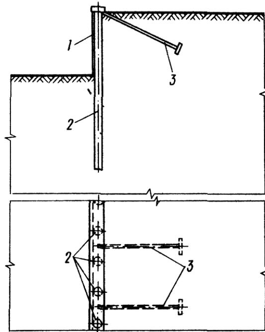
Рис.5. Однорядные подпорные стенки с буронабивными сваями с ростверком и анкерами
