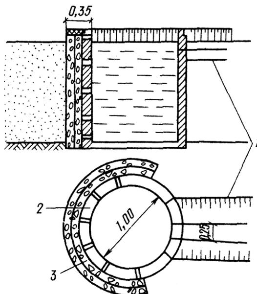
Рис. 63. Схема устройства каптажей в виде колодца
