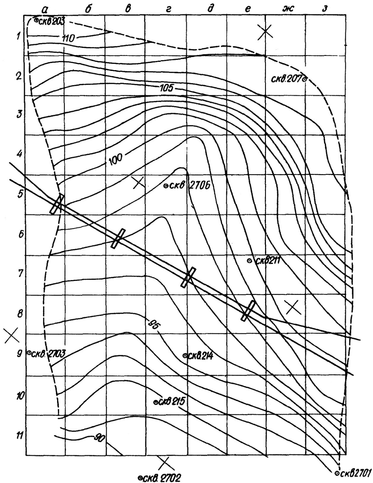
Рис. 30. Топографический план оползневого участка
