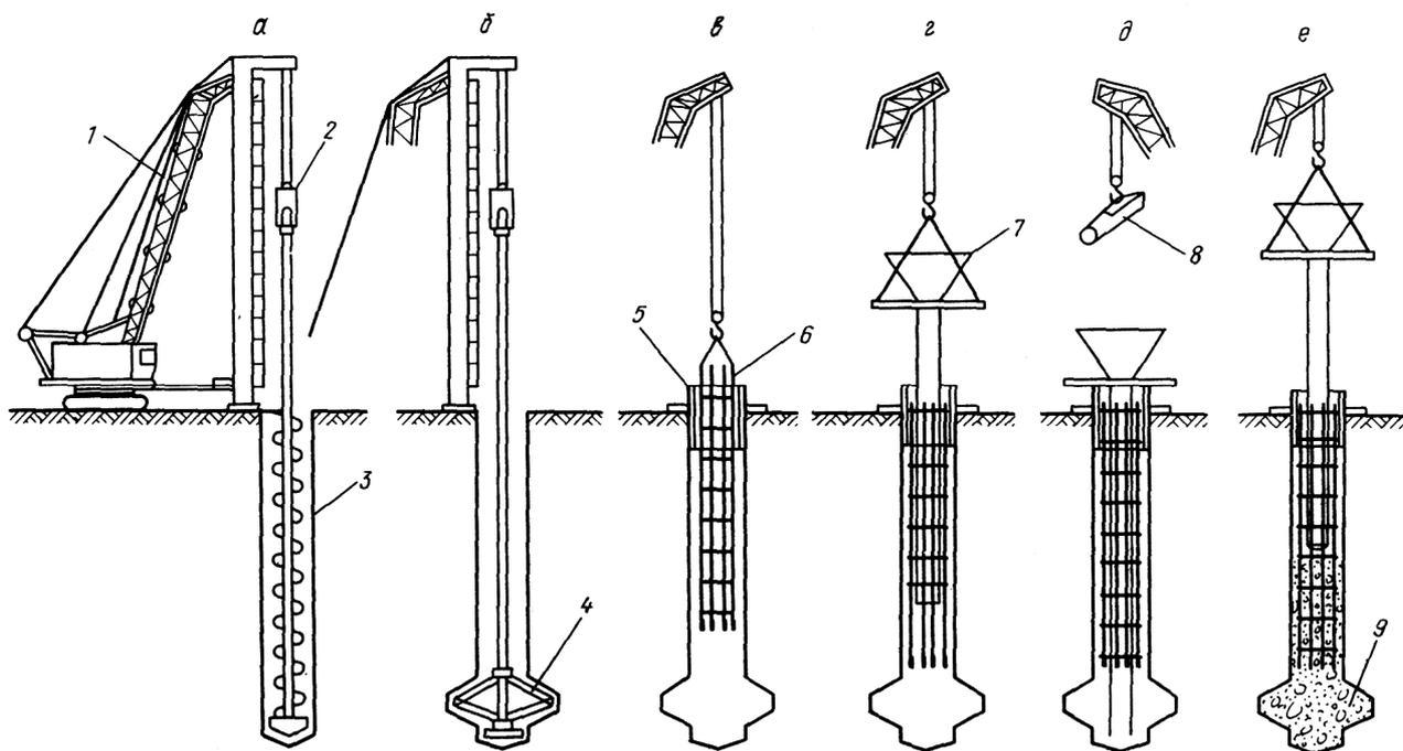
Рис. 72. Схема устройства буронабивных свай с уширенной пятой сухим способом
