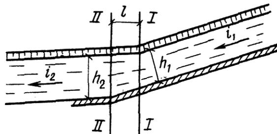
Рис.62. Схема определения сопряжения уклонов
