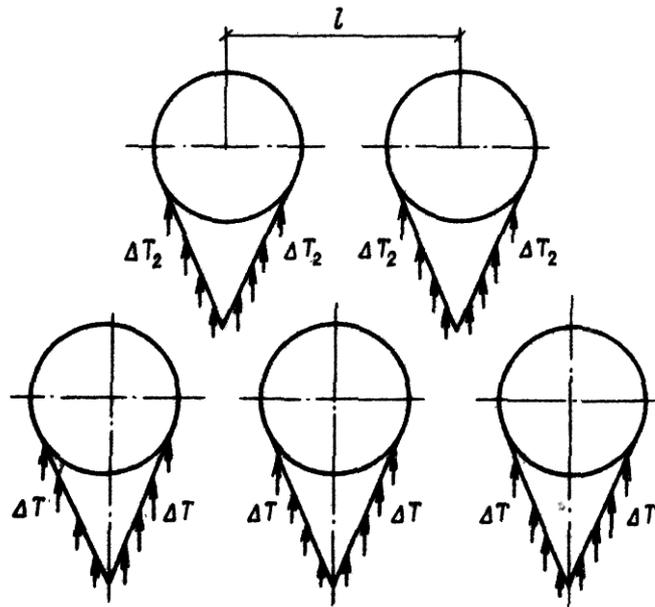
Рис.48. Схема расчета многорядного свайного ограждения
