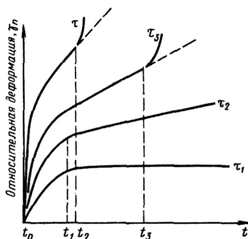
Рис.22. График испытаний грунтов на ползучесть
