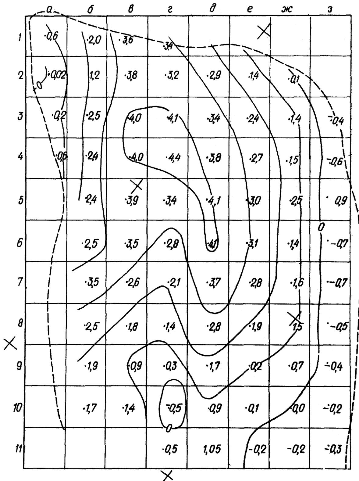
Рис.36. План силового поля оползневого склона
