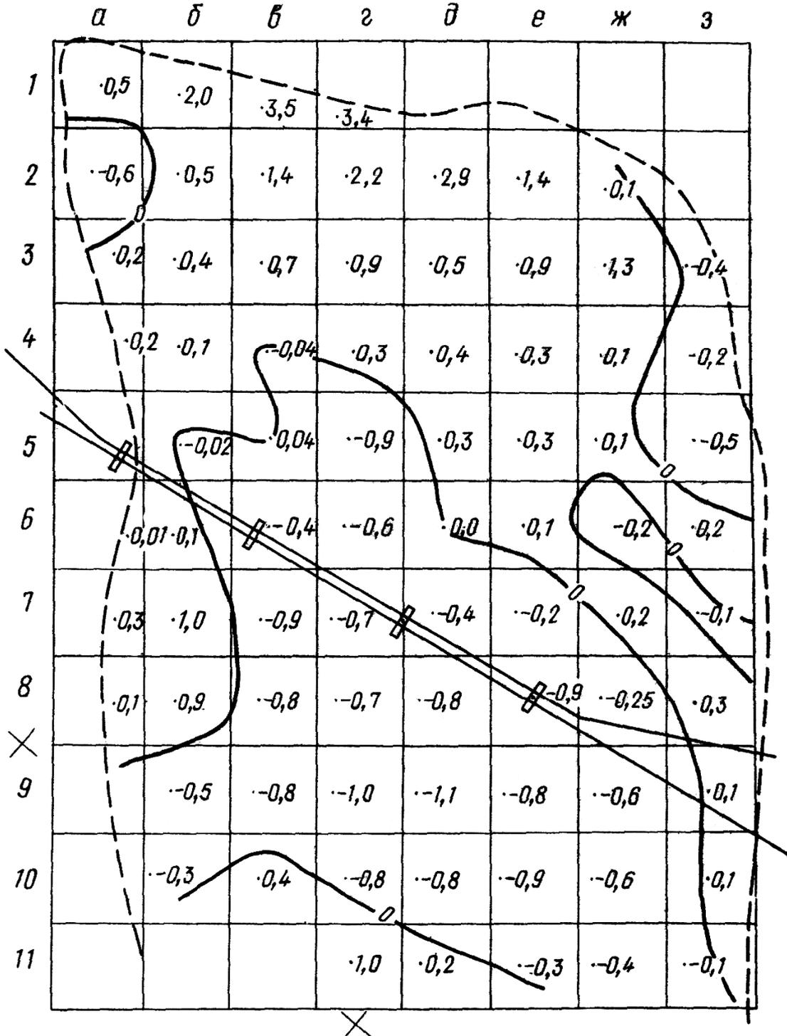
Рис.57. Оконтуривание зон пассивного оползневого давления на оползневом участке
