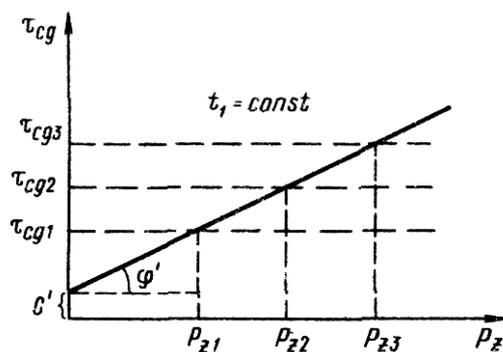
Рис.25. График зависимости сдвигающих напряжений от вертикальной нагрузки
