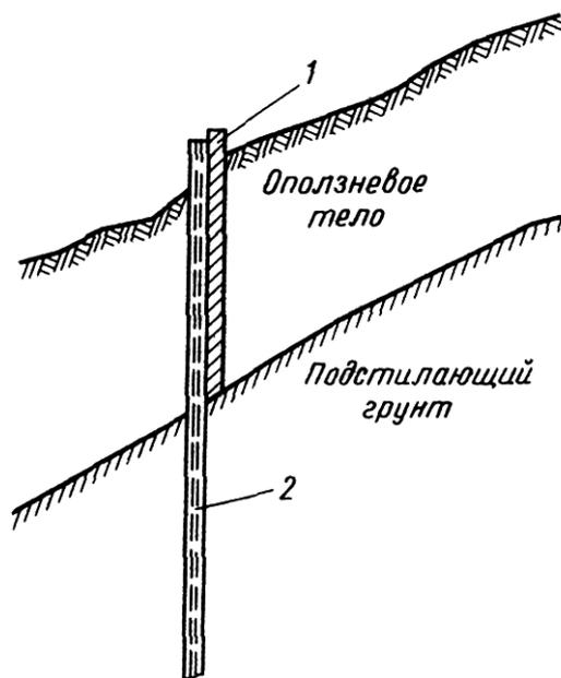
Рис. 49. Схема конструкции свайно-панельной удерживающей стены
