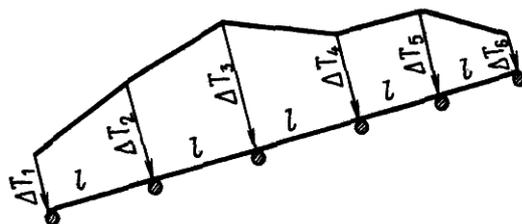
Рис.50. Эпюра оползневое давления на свайно-панельную удерживающую стену
