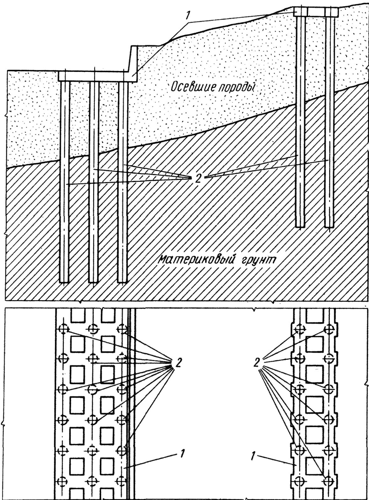
Рис.15. Удерживающие противооползневые сооружения из отдельных свайных полей
