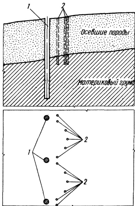
Рис.7. Свайное ограждение из однорядных набивных свай и систем грунтонабивных свай
