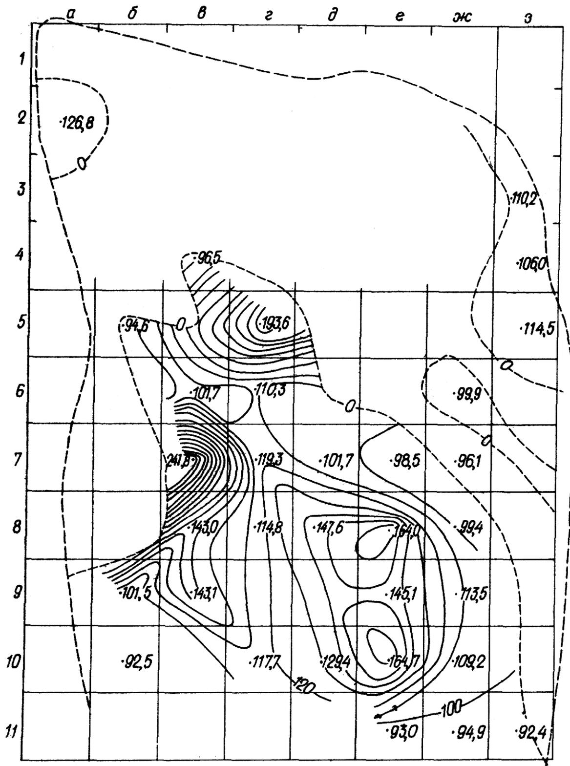
Рис.59. План устойчивой проектной поверхности оползня
