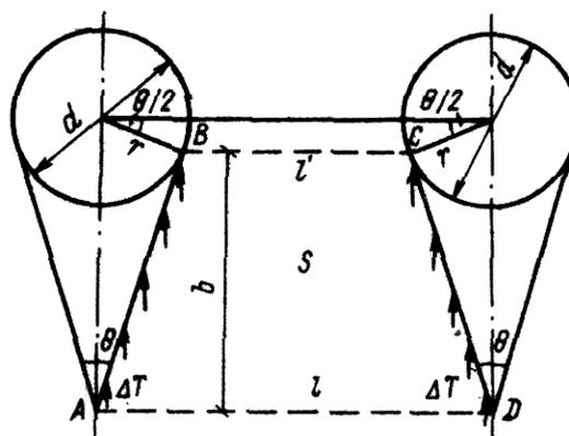
Рис.47. К расчету расстояния между сваями при однорядном свайном заграждении
