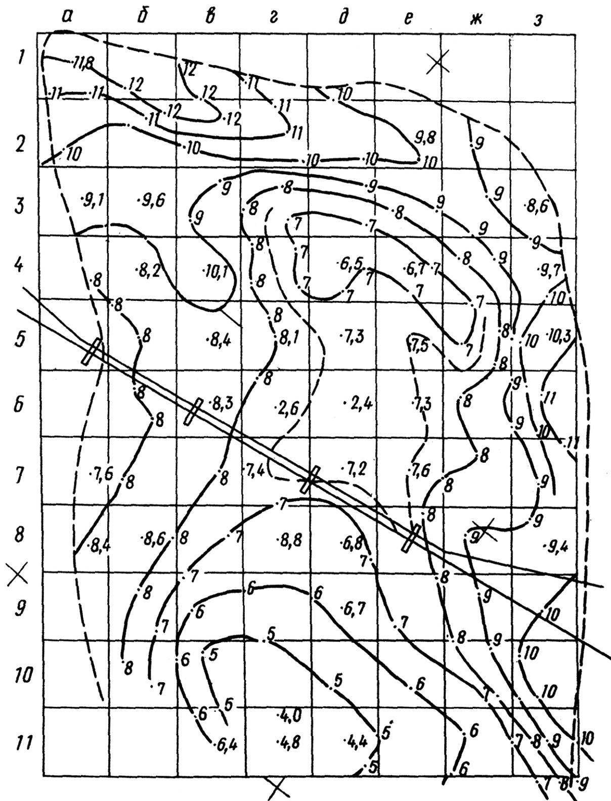
Рис.32. Изолинии изомощности оползня
