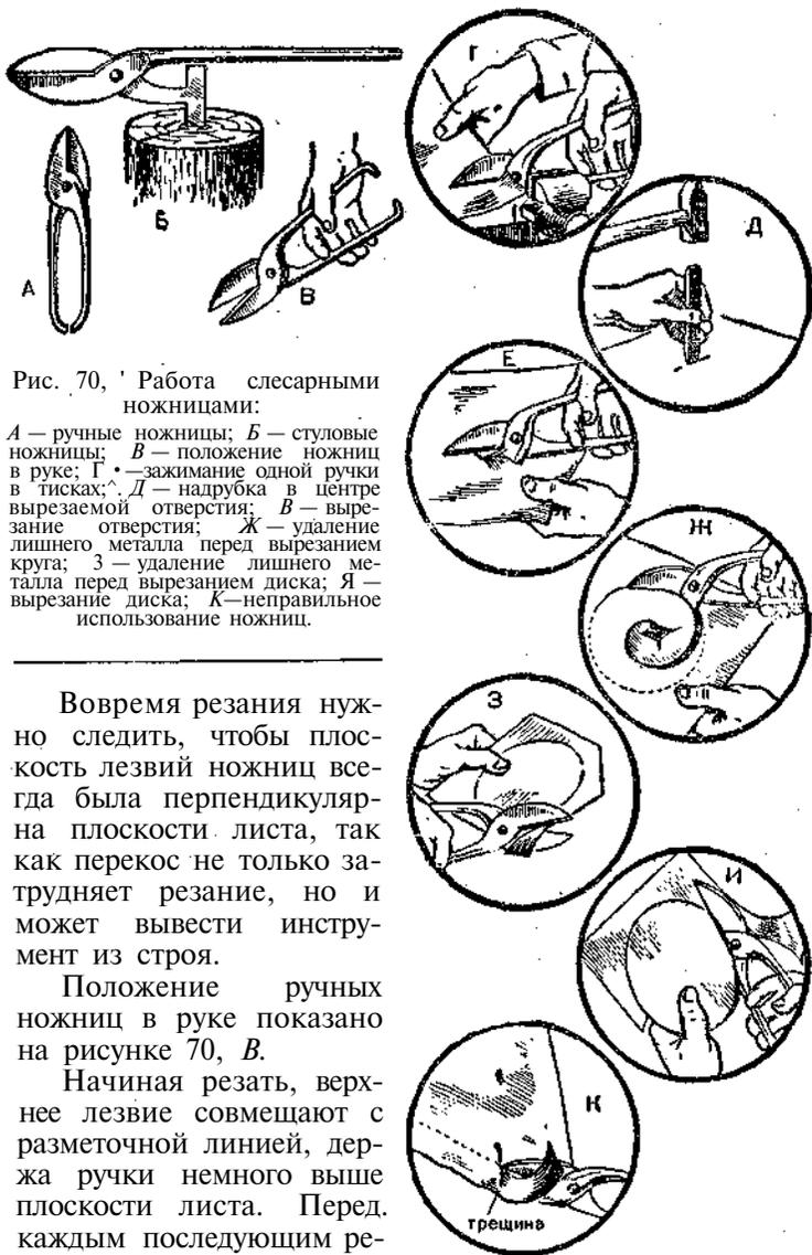
Рис. 70. Работа слесарными ножницами:
