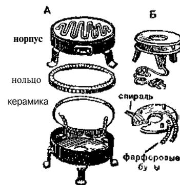
Рис. 155. Электрическая плитка: Л — с открытым нагревательным элементом, Б — с закрытым нагревательным элементом.
