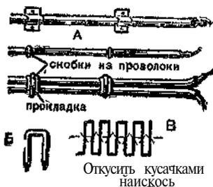
Рис. 147. Закрепление звонковой и радиопроводки: *Л* — скобами из жести; *Б* — скобами из проволоки; *В* — изготовление проволочных скоб.
