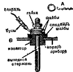
Рис. 156. Выводные контакты электронагревательных элементов:
