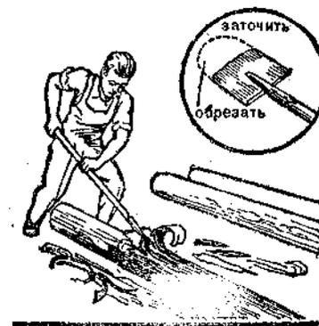
← Рис. 19. Удаление, коры при помощи старой лопаты.
