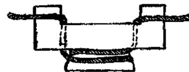
Рис. 201. Инструмент для натягивания веревок.
