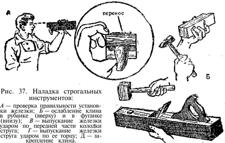
Рис. 37. Наладка строгальных инструментов:
