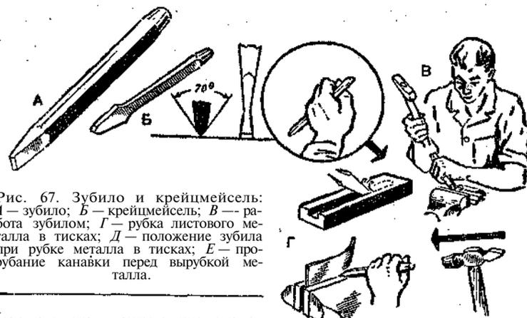
Рис. 67. Зубило и крейцмейсель: А — зубило; Б — крейцмейсель; В — работа зубилом; Г — рубка листового металла в тисках; Д — положение зубила при рубке металла в тисках; Е — прорубание канавки перед вырубкой металла.
