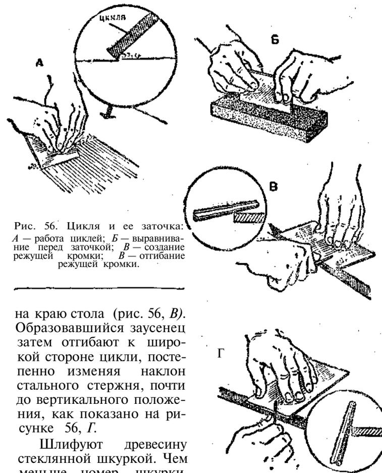
Рис. 56. Цикля и ее заточка: А — работа циклей; Б — выравнивание перед заточкой; В — создание режущей кромки; Г — отгибание режущей кромки.
