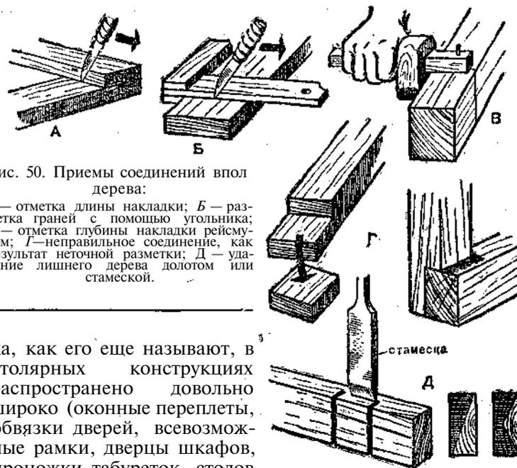
Рис. 50. Приемы соединений вполдерева:
