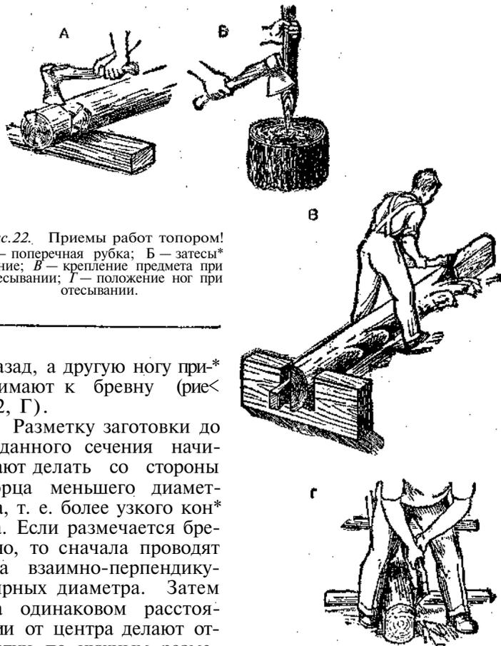
Рис. 22. Приемы работ топором: А — поперечная рубка; Б — затесывание; В — крепление предмета при отесывании; Г — положение ног при отесывании.
