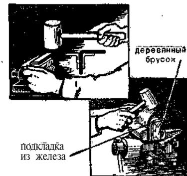
Рис. 81. Приемы гнутья листового металла
