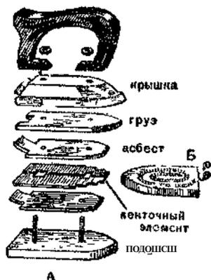
Рис. 159. Электрический утюг и его устройство: Л — с ленточным нагревательным элементом; В — со спиральным нагревательным элементом.
