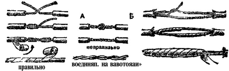
Рис. 135 Соединение проводов: А — одножильного, Б — двухжильного.
