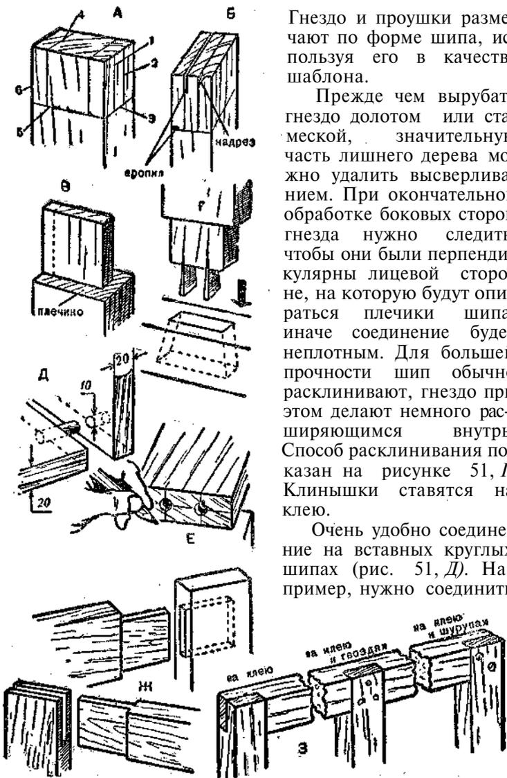
Рис. 51. Приемы соединения шипом:
