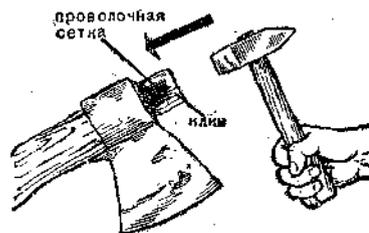
Рис. 25. Крепление клина при помощи сетки.
