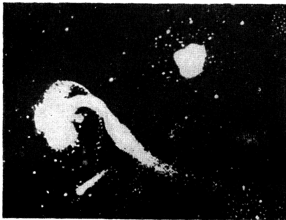
Рис. 5. Погашенные алюминиевые частицы диаметром 150 мк в ранней стадии воспламенения.
