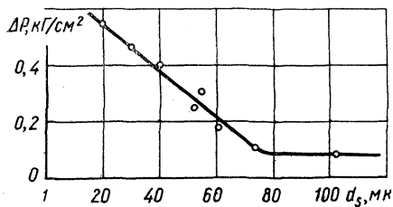
Рис. 88. Влияние крупности частиц на давление взрыва.
