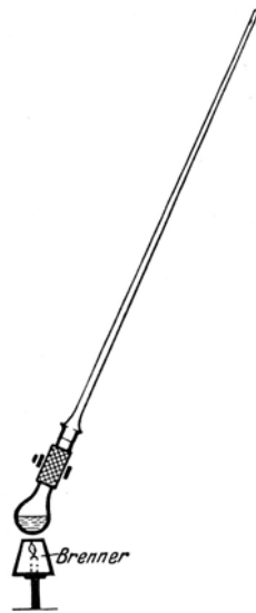
Abb. 15. Aufschlußgerät nach KÜRSCHNER und HANAK.
