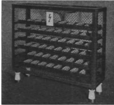
Bild 163. Kupferoxydulgleichrichter für 2000 V, 0,25 A (SSW.)
