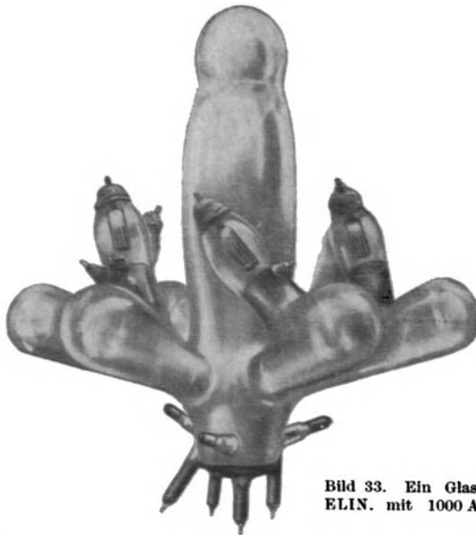
Bild 31. Ein Glasgefäß mit zweifach geknickten Anodenarmen und zweifachen Armverlängerungen, für höhere Spannungen
