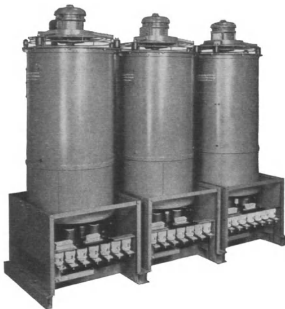
Bild 148. Luftgekühlte pumpenlose Eisengleichrichter für 500 A (J. Pintsch)
