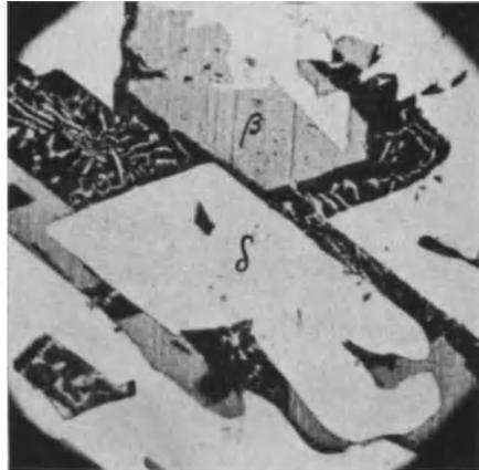
Abb. 258. Gefügeaufbau einer Legierung mit 10% Sn, 50% Sb und 40% Pb (Feld 2 in Abb. 256). (Nach HEYN und BAUER.) 100 $\times$ .
