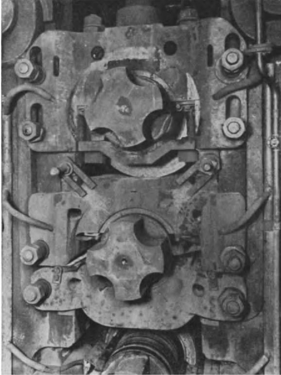
Abb. 133. Walzenlager im Gerüst einer Trio-Walzenstraße von 850 mm Ballendurchmesser. Die beiden oberen Segment-Walzenlager liegen unmittelbar auf der gedrehten Unterlage von Einbaustücken gemäß Abb. 132. Die mit Gummischlauchstücken an die Brausen angeschlossenen Köhlsammelleitungen für die Wasserkühlung der Lager sind links und rechts von den Lagern zu sehen.
