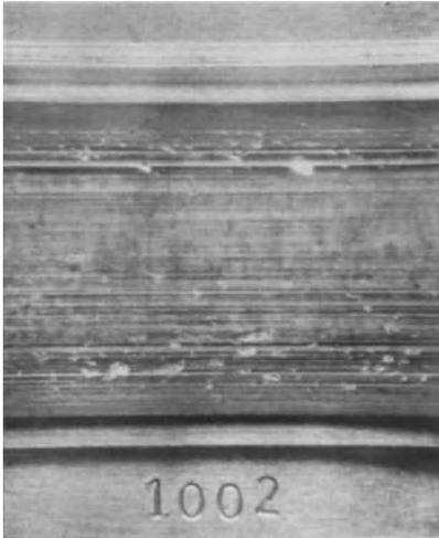
Abb. 170. Lauffläche eines durch Risse zerstörten Verbundlagers Nr. 3 (Zahlentafel in Abb. 167) nach 48stündigem Prüflauf unter ruhender Belastung von  $400 \text{ kg/cm}^2$ .  $2 \times$ .
