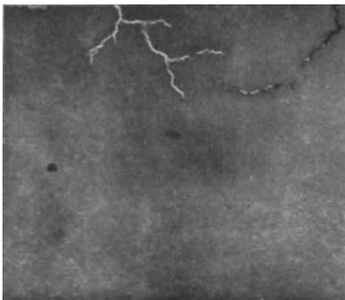
Abb. 244. Röntgenaufnahmen von Bleibronze-Verbundgußlagern (Positiv). Spannungsrisse.
