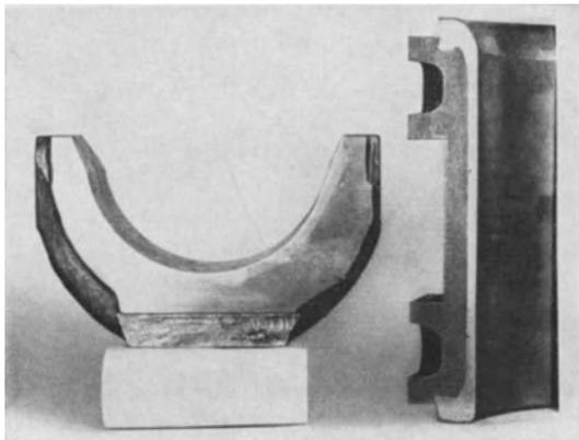
Abb. 239. Achslager der Deutschen Reichsbahn aus Stahl mit Bleibronze-Ausguß.
