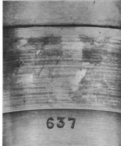
Abb. 169. Lauffläche eines Leichtmetall-Lagers „Nr. 4“ (Zahlentafel in Abb. 167) nach 107-stündigem Prüflauf unter ruhender Last von  $400 \text{ kg/cm}^2$ . Seitlich zahlreiche flache Narben und schwache Ausbruchstellen; im übrigen schwache und einige mittlere Riefen.  $2\times$ .
