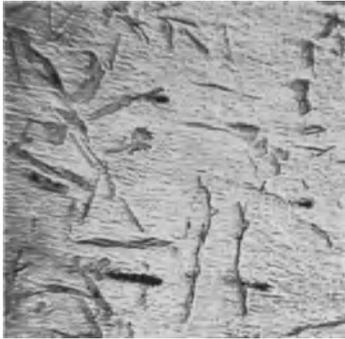
Abb. 144. Gußgefüge der Gleitlagerlegierung „Lg 40“. 48 $\times$ . (Nach H. WIECHELL.)
