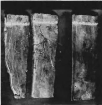
Abb. 64. Keilprobeguß für Lagermetalle verschiedener Dünnflüssigkeit.
