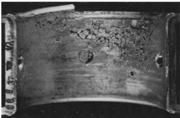
Abb. 286. Durch dynamische Druckbeanspruchung zerstörte Weißmetall-Laufläche (Höchstdruck:  $165 \text{ kg/cm}^2$ , Umfangsgeschwindigkeit  $8,5 \text{ m/s}$ , Lagertemperatur  $120^\circ$ , Gesamtlauzeit  $146\frac{3}{4}$  Stunden).
