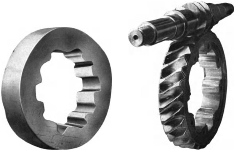
Abb. 194. Geschleudertes Schneckenradkörper und bearbeitetes Schneckenrad aus Zinnbronze mit 12% Sn.
