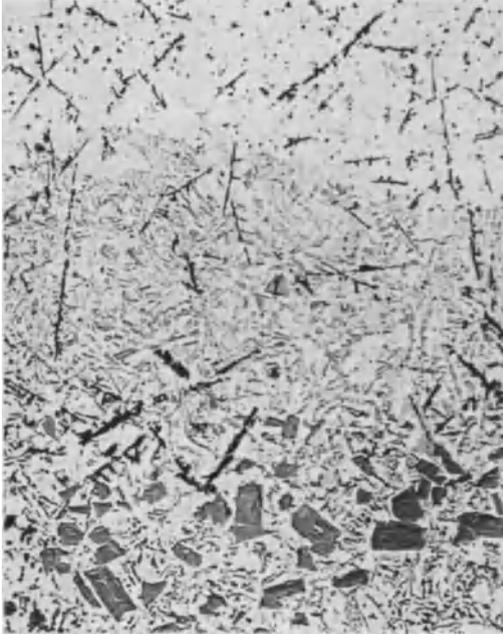
Abb. 143. Gefügebau der Verbundlagerlegierung „KS 13“, „KS 280“ in der Übergangszone. 150 $\times$ .
