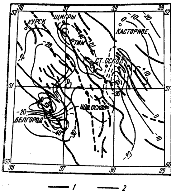
Рис. 41. Общая схема сопоставлений осей Курских магнитных аномалий и аномалий силы тяжести в редукции Буге (составил Ф. Ф. Федынский). Плотность промежуточного слоя—2,67; нормальная формула Гельмерта (1909 г.)
