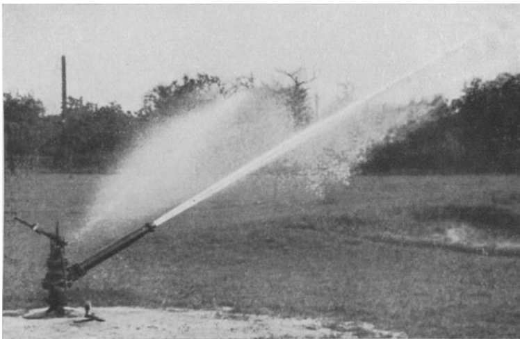
Abb. 10. Regenkanone, feststehend, auch fahrbar zu liefern.
