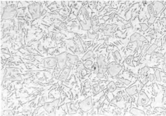
Abb. 21. Schlibfbild einer Alusil-Kolbenlegierung.
