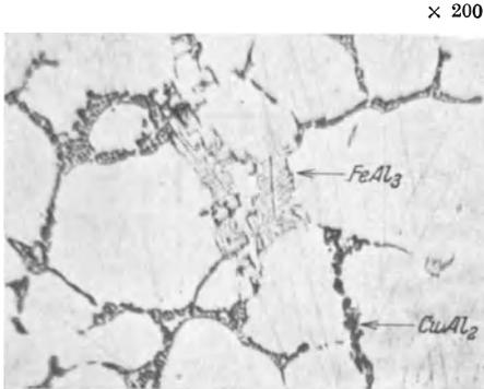
Durch Ätzung mit 4proz. alkoholischer Pikrinsäure sind die  $\text{CuAl}_2$ -Kristalle dunkel und die  $\text{FeAl}_3$ -Kristalle (in Form chinesischer Schriftzeichen) heller gefärbt. Infolge der geringeren Löslichkeit des Kupfers im Aluminium bei Zimmertemperatur mit 0,4% gegenüber 5,6% bei der eutektischen Temperatur von  $548^\circ$  sind die Al-Cu-Legierungen aushärtbar, wodurch sie beachtliche Festigkeitseigenschaften erhalten.
