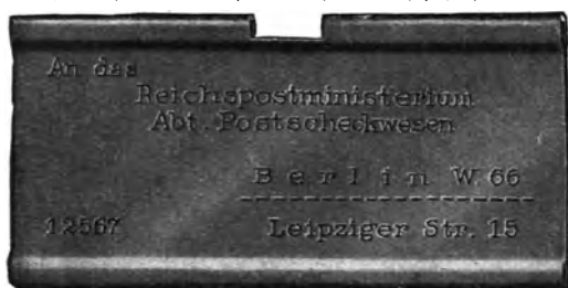
Abb. 14: Druckplättchen der „Adrema“- Adressiermaschine. (Adrema-Maschinenbau-Gesellschaft, Berlin.)
