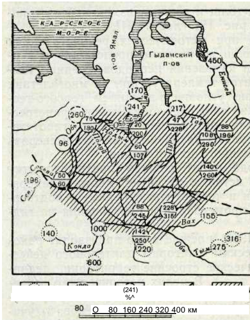
Рис. 165. Схематическая карта распространения многолетнемерзлых пород в Западной Сибири (Баулин, 1958): 1 — скважины без мерзлых пород, глубина скважины; 2 — скважины, вскрывшие второй слой мерзлых пород: числитель — глубина юрволы второго слоя, знаменатель — глубина, до которой эти породы пройдены; 3 — скважины, вскрывшие мерзлые породы с поверхности и глубина залегания последних; 4 — граница верхнего слоя мерзлых пород (по И. И. Сумгину); 5 — районы с двуслойным строением мерзлых пород. Карта составлена по материалам ЗСГУ, ВСЕГЕИ, Гидропроекта и НИИГА
