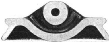
Abb. 154. Schnitt durch einen Hewlett-Hängeisolator.
