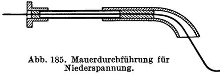
Abb. 185. Mauerdurchführung für Niederspannung.
