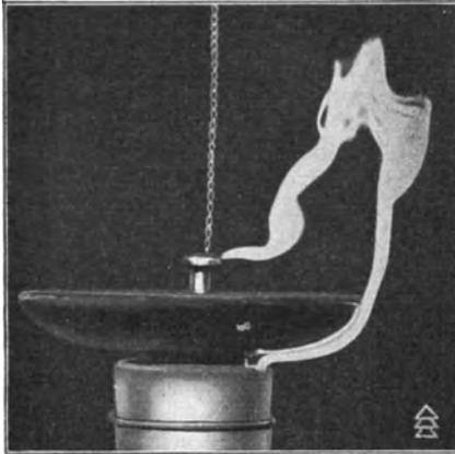
Abb. 168. Überschlag eines Kappenisolators bei Wechselspannung.
