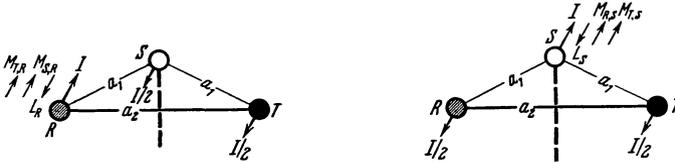
Abb. 52. Einfache Drehstromleitung; unsymmetrische Anordnung.
