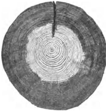
Abb. 195. Mastschnitt durch eine teerölimprägnierte Kiefer.
