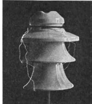
Abb. 140. Gleitfunken an einem Stützenisolator in trockener Luft.
