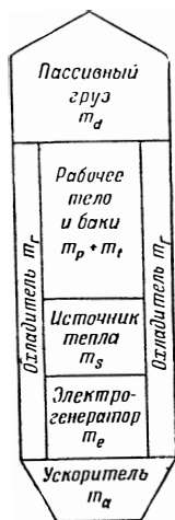
Ф и г. 9.10. Схемы ракеты и двигателя с ускорителем частиц
