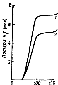
Рис. 8.18. Термогравиметрические диаграммы: 1 — \text{H}_2\text{Nd}(\text{ДТПА}) \cdot 7\text{H}_2\text{O} ; 2 — \text{H}_2\text{Er}(\text{ДТПА}) \cdot \text{H}_2\text{O}
