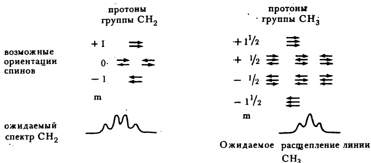
Рис. 9.7. Возможная ориентация ядерного спина протонов \text{CH}_2 - и \text{CH}_3 -групп
