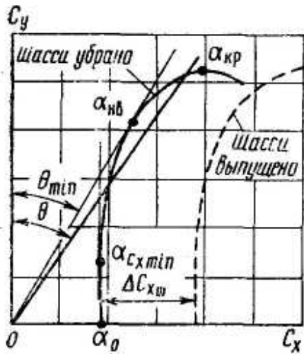
Рис. 21. Поляра самолета и характерные точки на ней (вариант)
