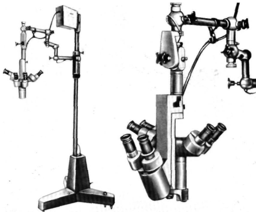
7.112. Триплоскоп 7-Р/Н Карла Цейса Ю'Брайн Б.. 19811.
