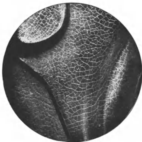
Abb. 28. Rißbildung infolge von Oberflächenspannungen an einem Gesenk (TWL 395).
