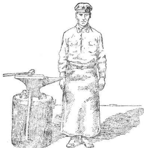
Рис. 31. Высота наковальни со стулом
