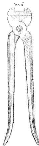
Рис. 125. Щипцы для стягивания аграфов
