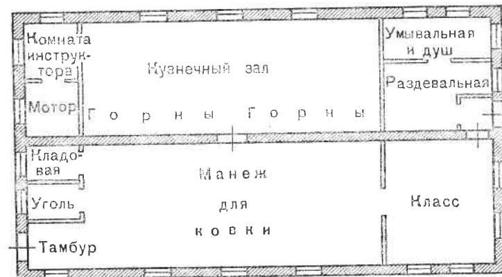
Рис. 22. План войсковой кузницы на 3 горна (6 огней)
