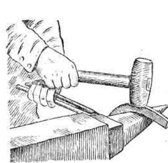
Рис. 50. Протягивание и выравнивание ветви
