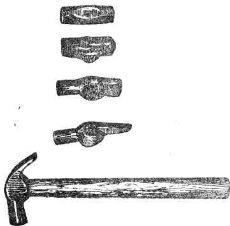
Рис. 142. Последовательные стадии выделки ковочного молотка
