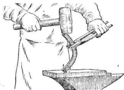
Рис. 49. Сгибание бруска; А—первый прием; Б—второй прием
