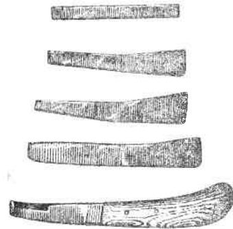
Рис. 145. Последовательные стадии выделки копытного ножа.
