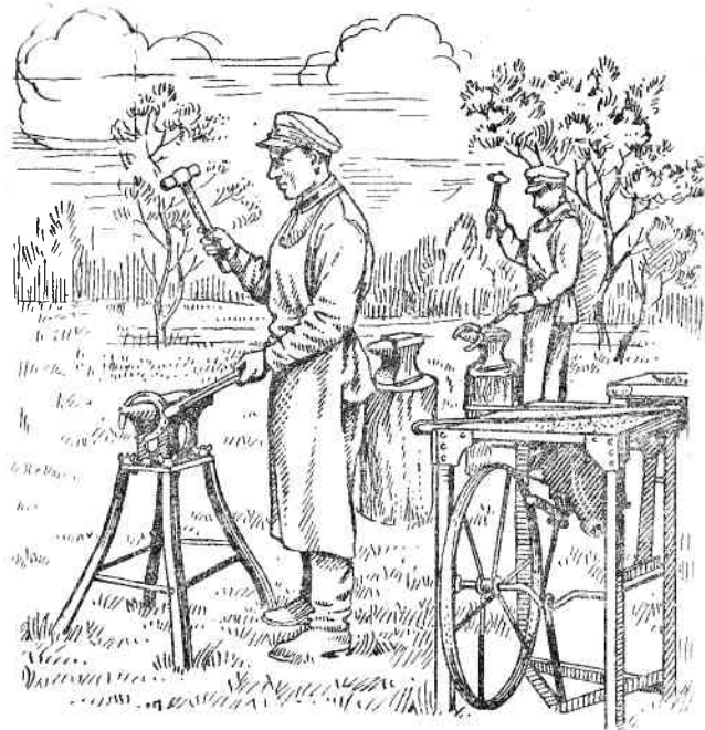
Рис. 35. Облегченная (полая) наковальня
