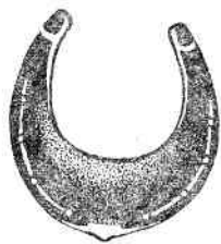
Рис. 120. Подкова для плоского копыта с глубокой бухтовкой
