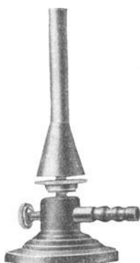
Fig. 18. Bunsenbrenner nach Teclu.
