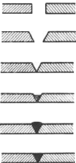
Fig. 62. Stumpflötung zweier Bleche.
