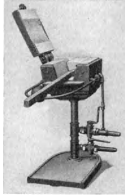
Abb. 7. Tisch-Gasfeuer (Schuchardt & Schütte A.G.).
