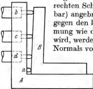
Abb. 9. Apparat zum Vergleich von 90°-Stahlwinkeln mit einem Normal.
