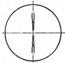
Abb. 83. Strichplatte der Mikroskope des Teilkreisprüfapparates.
