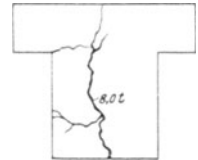
Abb. 54. Ribbildung in der Stirn des Balkens 3b (ohne Bügels, Längseisen 26 mm.)
