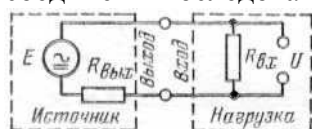
Рис. 144. К источнику напряжения E с внутренним сопротивлением R_{вн} подключена нагрузка с входным сопротивлением R_{вх} ; U — напряжение на выходе.
