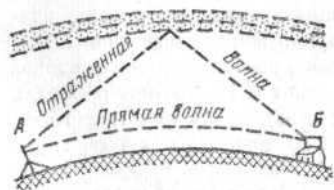
Рис. 111. Волна передатчика А доходит до приемника Б двумя разными путями: прямо и после отражения в верхних слоях атмосферы от ионизированного слоя воздуха.
