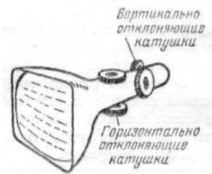
Рис. 183. Катушки, создающие магнитные поля, обеспечивают отклонение электронного луча.
