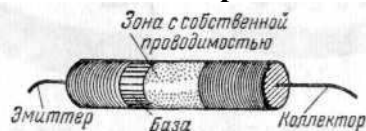
Рис. 135. Транзистор, в которой между базой и коллектором имеется зона из полупроводника с собственной проводимостью, улучшающая усиление на высоких частотах.
