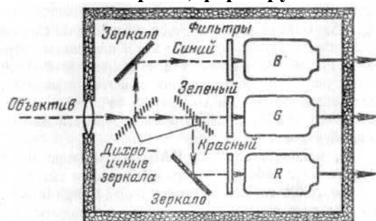
Рис. 209. В передающей цветной телевизионной камере зеркала распределяют изображение между тремя передающими трубками, перед которыми установлены фильтры основных цветов.
