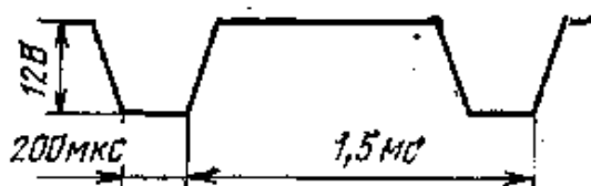
Рис. 43. Эпюра напряжения на выходе модулятора
