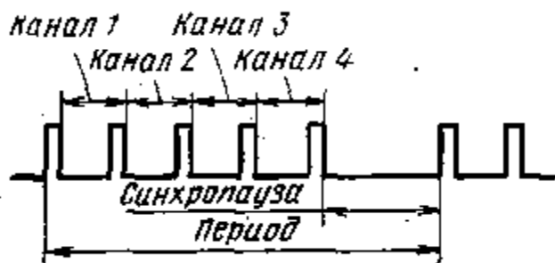
Рис. 6. Структура импульсной последовательности в каналах с синхронизацией паузой
