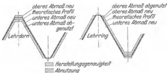
Abb. M 18. Lage der Herstellungsgenauigkeit und Abnutzung der Gutlehren für das Metrische Gewinde.
