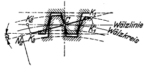
Abb. Z 5. Zahnstange. Eingriffsstrecke. Überdeckungsgrad.
