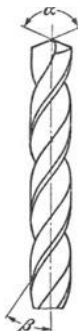
Abb. B 16. Spiralbohrer für Aluminium \alpha = 130-140^\circ , \beta = 35-45^\circ , v = 50-200 \text{ m/min} für SS-Bohrer; Spiralbohrer für Kupfer \alpha = 125^\circ , \beta = 35-45^\circ , v = 35-70 \text{ m/min} für SS-Bohrer.
