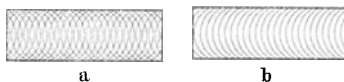
Abb. S 8a und b. Schleifbild bei genau senkrecht stehender und bei etwas geneigter Schleifspindel.
