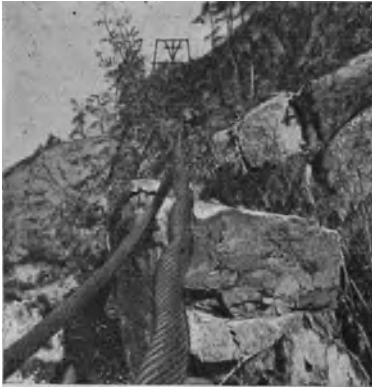
Abb. 624. Verformung eines fehlerhaften Laufseiles.
