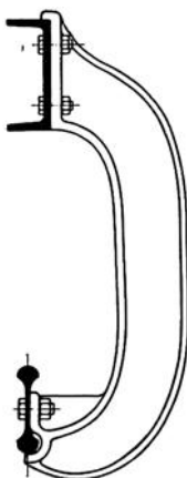
Abb. 245. Hängeschuh für Eisenbauten (Bleichert).
