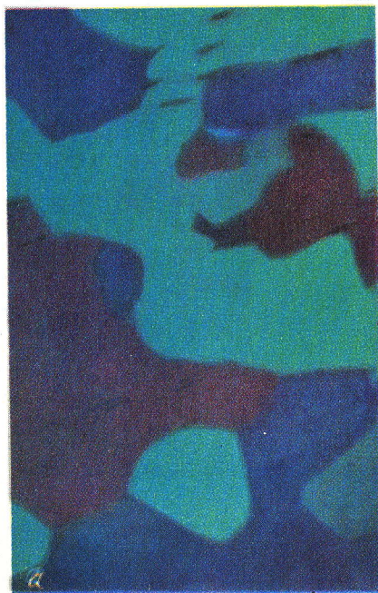
Рис. 4. Структура прутков вольфрама после рекристаллизационного отжига а — зеленый цвет — плоскость (111), синий — (100), красный — (110); б — зеленый цвет — (111), желтый — (100)
