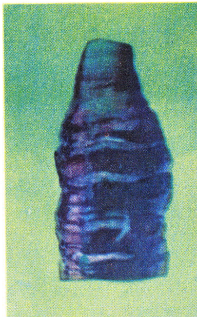
Рис. 3. Монокристалл произвольной ориентации с выходом плоскостей (111) и (100)
