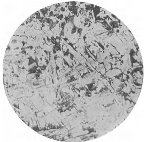
Abb. 318. Stahlguß mit 0,27% C, bei 750° geglüht, Ätzung II, x 80.
