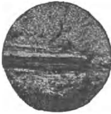
Abb. 403. Zerreißstab mit Schieferbruch, x 3.
