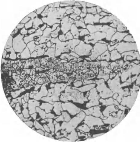
Abb. 390. Zusammengeschweißter Hohlraum mit innen oxydierten Wänden, Ätzung II, x 100.
