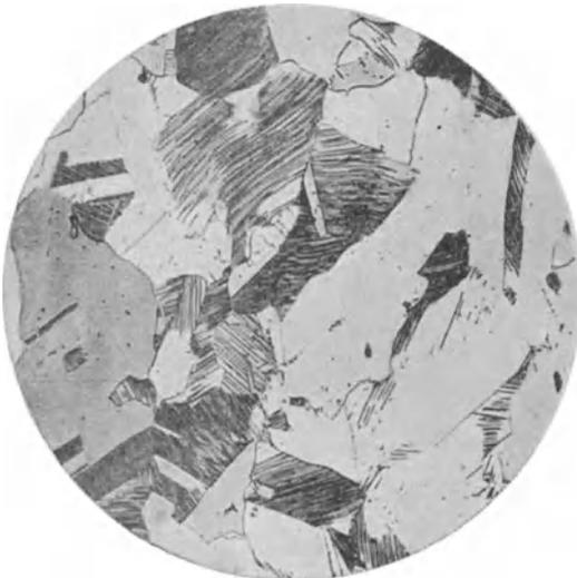
Abb. 508. Austenitisch. Nickelstahl (25% Ni), Anlieferungszustand, Ätzung Ammonium-Per-sulfat,  $\times 500$ .
