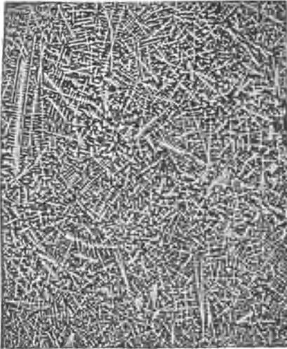
Abb. 92. Dendritische Schichtkristalle in einem Stahl mit 0,8% C und 0,13% P, Ätzung I, x 2.
