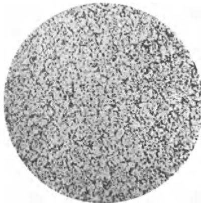
Abb. 502. Stahl mit 1,05% C, 1,6% Cr, 10 min auf 800° erhitzt, in Öl abgeschreckt, Natriumpikratätzung x 500 (Emicke).
