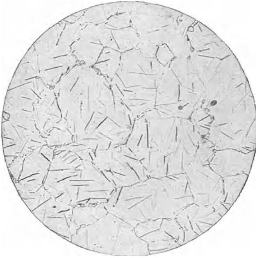
Abb. 167. Eisen-Stickstoff-Legierung mit hohem Stickstoffgehalt, ungeätzt, x 100.
