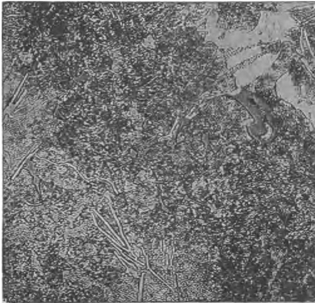
Abb. 299. Zementit innerhalb der Gasblasenseigerung. Ätzung II, x 200.
