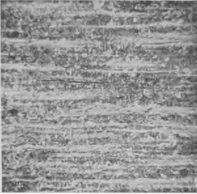
Abb. 458. Kesselblech im Anlieferungszustand, Ätzung I, x 50.
