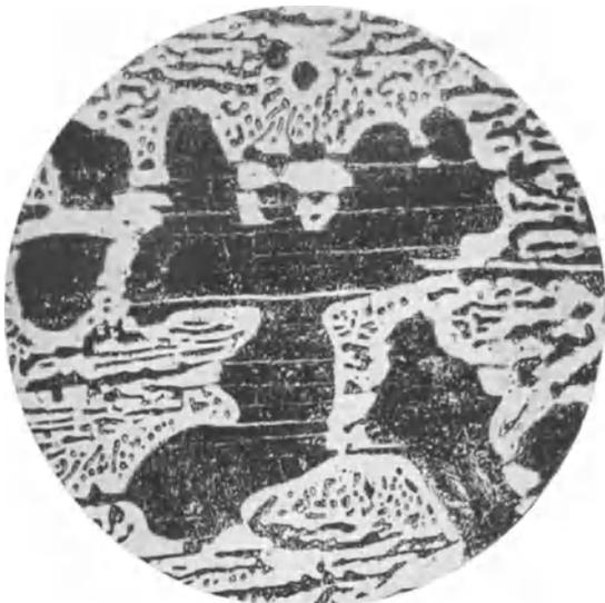
Abb. 29. Sekundärer Zementit in den Mischkristallen, Ätzung II, x 300.
