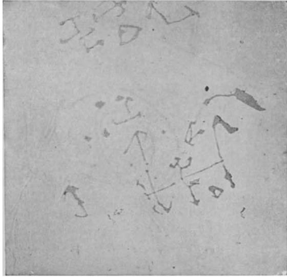
Abb. 297. Schwefelhaltige Einschlüsse innerhalb der Gasblasenseigerung Abb. 296, ungeätzt, x 200.
