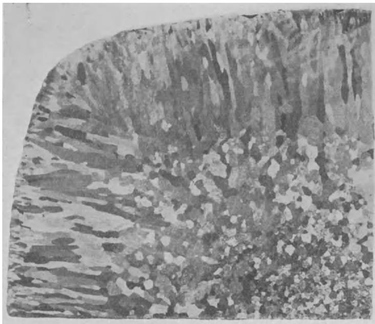
Abb. 248. Transformatorenmaterial,  $\frac{1}{4}$  Gußblock, Ätzung II, x 1.
