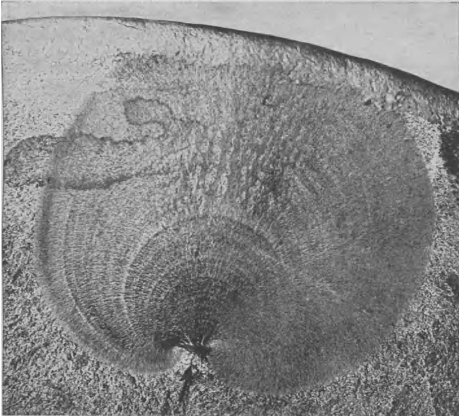
Abb. 377. Dauerbruch einer Feinblechwalze, x 1.
