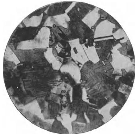
Abb. 128. Austenitischer Nickelstahl, 0,12% Kohlenstoff, 25% Nickel, Ätzung II, x 150. (Guillet.)
