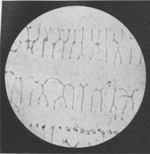
Abb. 98. Eisen-Schwefel-Legierung mit 2% Schwefel, ungeätzt, x 50.
