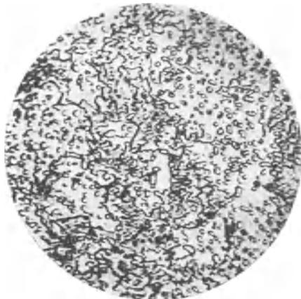
Abb. 501. Stahl mit 1,05% C, 1,6% Cr, 2 min auf 750° erhitzt, in Wasser abgeschreckt, Ätzung II, x 1000 (Emicke).
