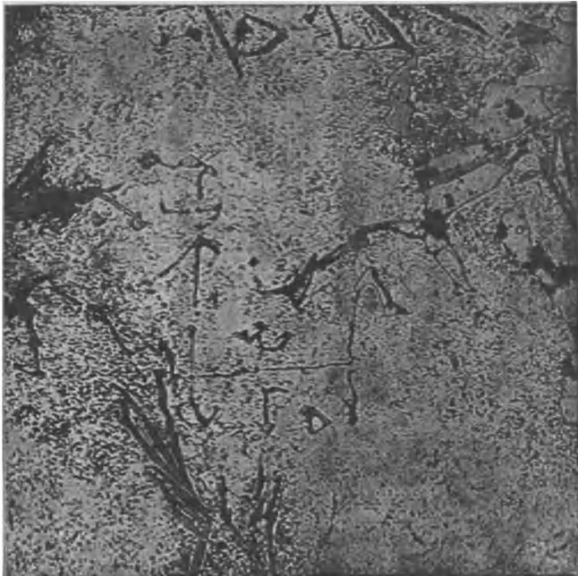
Abb. 300. Dieselbe Stelle wie Abb. 299, jedoch mit Natriumpikrat geätzt.
