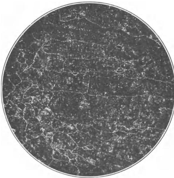
Abb. 269. Stahlguß mit 0,46% C, Ferrit in Zellen, Ätzung II,  $\times 5$ .
