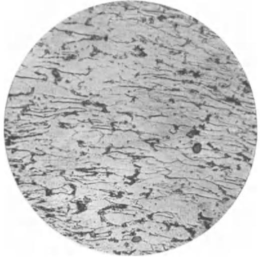
Abb. 340. Gezogene Zone eines um  $180^\circ$  gebogenen Stabes aus weichem Flußeisen, Ätzung II, x 100.
