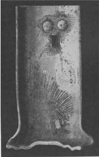
Abb. 345. Durch Rosten entwickelte Fließfiguren auf einer Eisenbahnschwelle, infolge von Stanzen, Nieten, Kappen.
