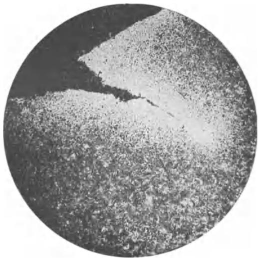
Abb. 446. Am Rande, bzw. an den Rißwänden entkohler Stahl. Ätzung II, x 100.
