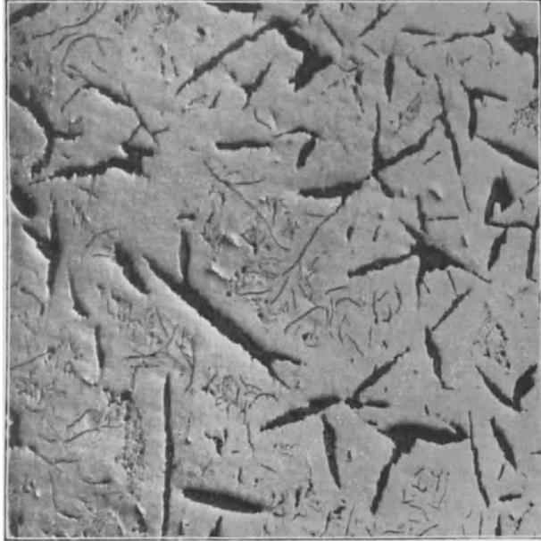
Abb. 86. Eisen-Kohlenstofflegierung mit 7% C, Gar-schaumgraphit und Graphiteutektikum. Ungeätzt, x 20.
