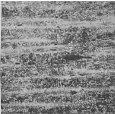
Abb. 460. Dasselbe Stück wie Abb. 458, auf 1250° erhitzt, an der Luft abgekühlt, Ätzung I, x 50.
