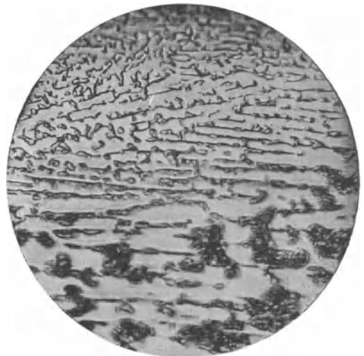
Abb. 468. Wie Abb. 467, jedoch starke Vergrößerung der äußersten Randzone (Ledeburit), Ätzung II, x 500.
