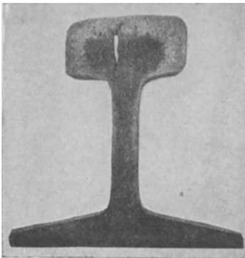
Abb. 392. Schiene mit unvollständig zusammengesweißtem und durch das Befahren wieder aufgequetschtem Lunker.
