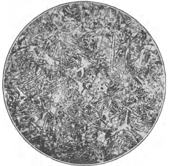
Abb. 325. Stahlguß mit 0,4% C,
