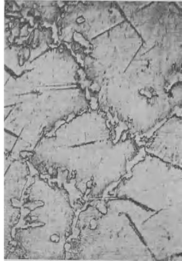
Abb. 507. Austenitischer Manganstahl auf  $900^{\circ}$  erhitzt und verhältnismäßig langsam abgekühlt, Ätzung II,  $\times 200$  (Rapatz).
