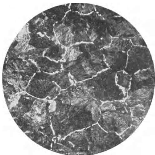
Abb. 22. Eisen-Kohlenstoff-Legierung mit 0,64% C, Ätzung II, x 100.
