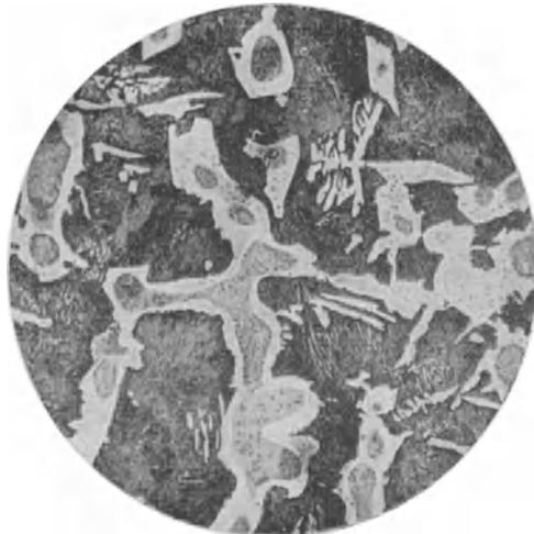
Abb. 253. Legierung mit 0,2% C und 0,6% P, ungleichmäßige Verteilung des Phosphors (Kristallseigerung), Ätzung II, x 100.
