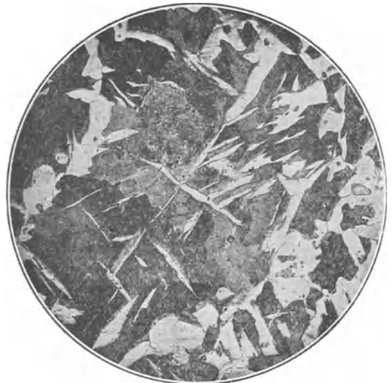
Abb. 327. Stahlguß mit 0,4% C,
