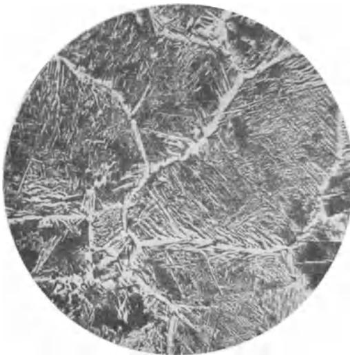
Abb. 445. Überhitzter Stahl mit 0,25% C. Ätzung II, x 50.
