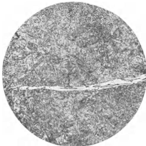
Abb. 431. Einfluß der Streckung der Schlackeneinschlüsse auf die Form der Ferritabscheidung bei der sekundären Zeilenbildung, Stahl mit 0,4% C bei 750° abgeschreckt, Ätzung II,  $\times 150$ .
