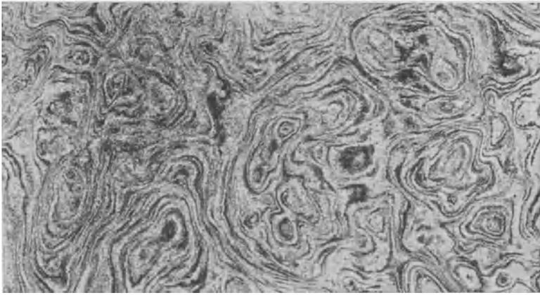
Abb. 427. Künstlich in einem Kesselblech erzeugtes Damaszenergefüge, Ätzung I, x 2.
