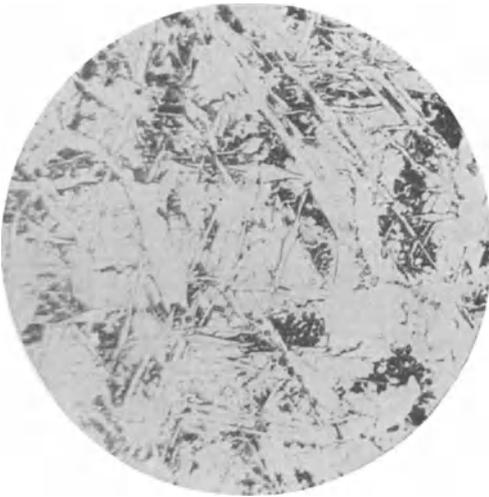
Abb. 319. Stahlguß mit 0,27% C, bei 800° geglüht, Ätzung II, x 80.
