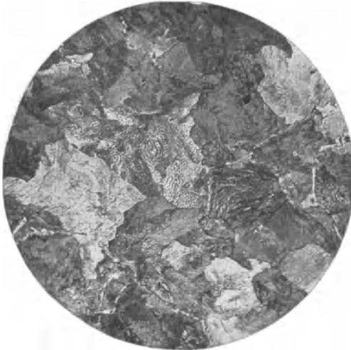
Abb. 46. Sorbit mit feinlamellarem Perlit, Ätzung II, x 300.
