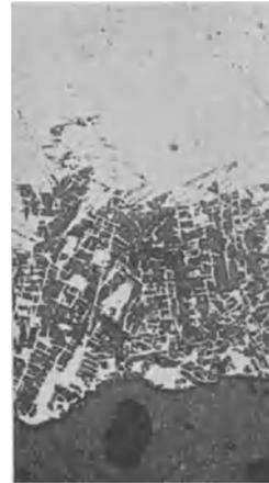
Abb. 571. „Schwarze Stelle“ am Lunker eines Tempergußstückes, Ätzung II, x 10.
