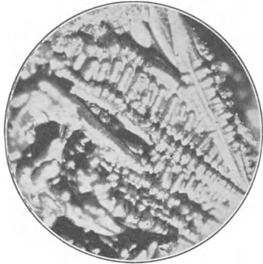
Abb. 292. Bruch des Zerreißstabes Abb. 291 mit vorhandenen Gasblasen.
