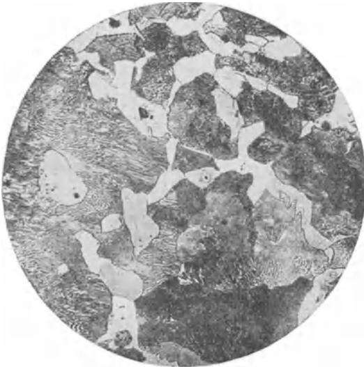
Abb. 449. Stahl mit 0,46% C in Kieselerde abgekühlt, Perlit lamellar.
