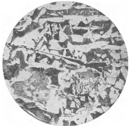
Abb. 396. Oxydreste am Ausläufer des Risses, Ätzung II,  $\times 100$ .
