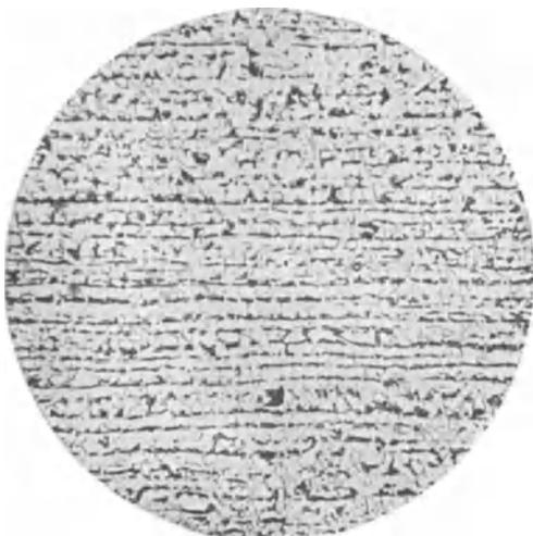
Abb. 430. Sekundäre, Zeilenstruktur, Ätzung II,  $\times 50$ .
