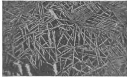
Abb. 455. Wie Abb. 454, jedoch von 1200 auf 785° rasch abgekühlt, 33 Minuten auf 785° gehalten und in Wasser abgeschreckt, kein Zementitnetzwerk. Ätzung II, x 40. (Howe und Levy.)
