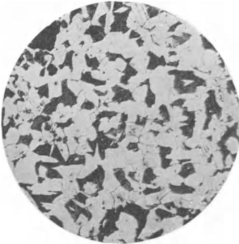
Abb. 321. Stahlguß mit 0,27% C, bei 900° geglüht, Ätzung II, x 80.
