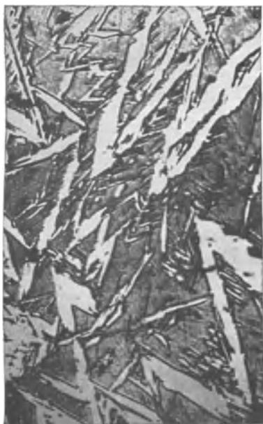
Abb. 75. Stahl mit 1,66% C bei 1050° abgeschreckt,  $\frac{2}{3}$  Austenit,  $\frac{1}{3}$  Martensit (Maurer), Ätzung II,  $\times$  400.
