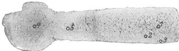
Abb. 549. Querschnitt durch einen richtig getemperten Schlüssel. Ätzung II, x 3.
