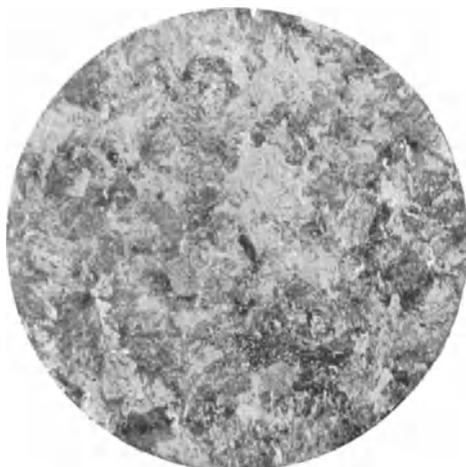
Abb. 23. Eisen-Kohlenstoff-Legierung mit 0,9% C, Ätzung II, x 100.
