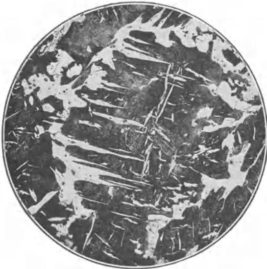
Abb. 324. Stahlguß mit 0,4% C,
