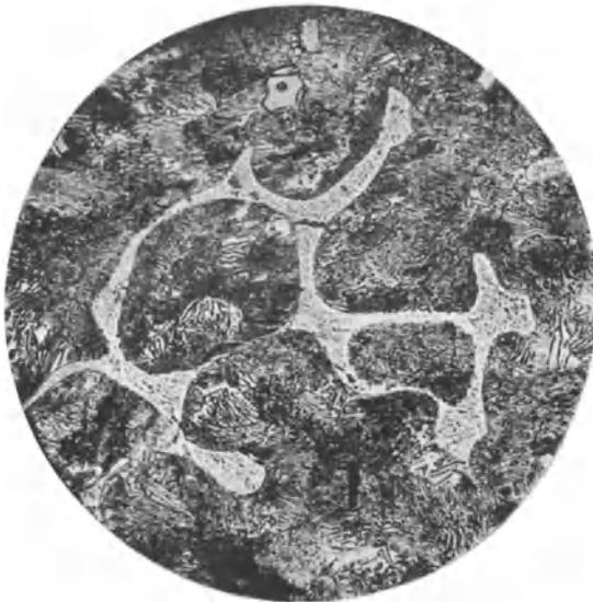
Abb. 96. Graues Roheisen mit Phosphideutektikum, Steadit. Ätzung II, x 100.
