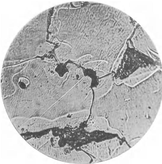
Abb. 440. Flußeisen zwischen  $A_1$  und  $A_3$  geglüht, Ferrithofbildung. Ätzung II,  $\times 300$ .
