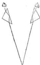
Abb. 53. CH. WHEATSTONES ( \beta .) Pseudoskop für nahe Gegenstände.
