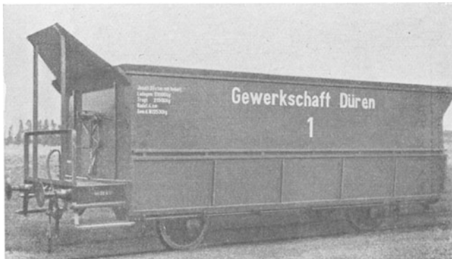
Abb. 79. Zweiachs. Selbstentlader (Sattelwagen) für Braunkohlen, 31 cbm Inhalt und 20 t Tragfähigkeit, Bauart Uerdingen.
