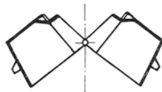
Abb. 44. Schema eines kurz gekuppelten Kübelwagens, geöffnete Kübel.
