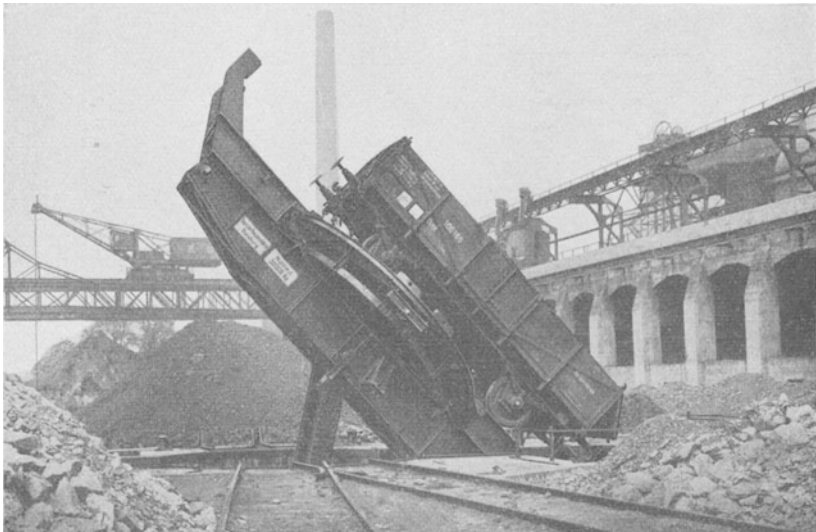
Abb. 160. Drehscheibenkipper (Demag) mit Drehscheibe auf der Kippbühne.
