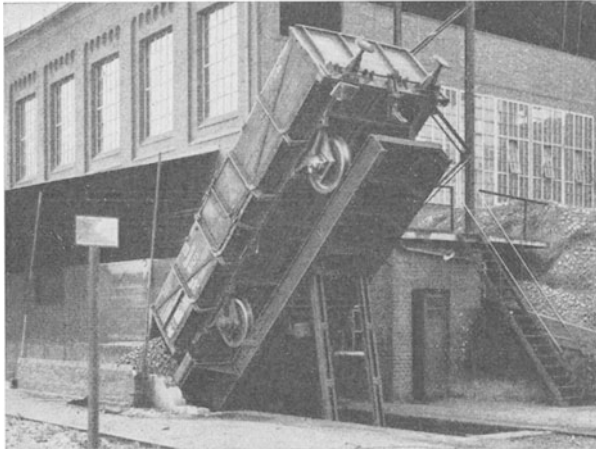
Abb. 146. Plattformkipper mit doppelten Hubstempeln.
