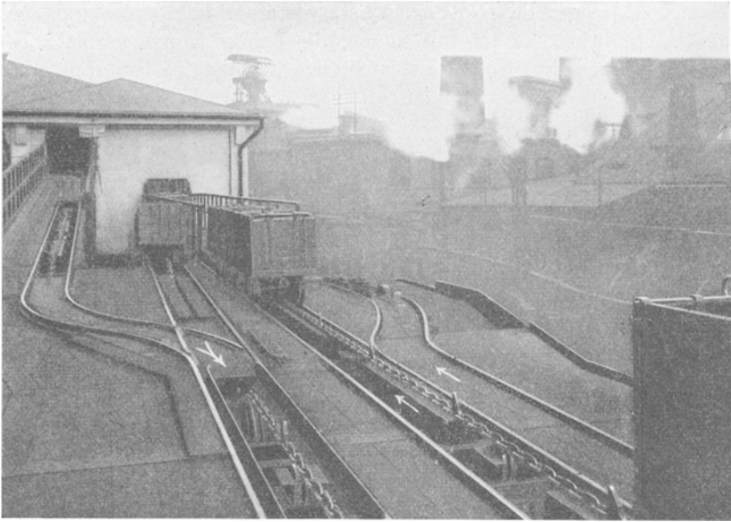
Abb. 318. Dreischienige Förderbahn (Heckel).
