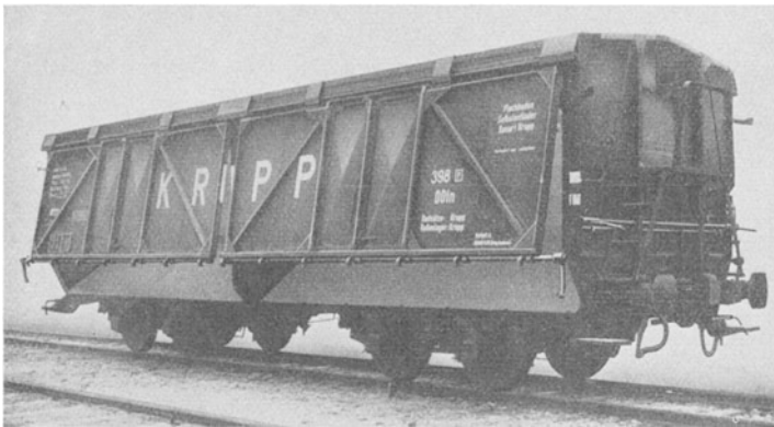
Abb. 103. Flachbodenselbstentlader, 50 t Tragfähigkeit, Bauart Krupp.
