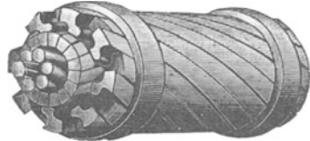
Abb. 404. Tragseil in vollverschlossener Machart mit Trapezdrähten.
