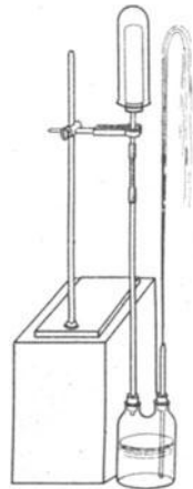
Fig. 6. Demonstration des Diffusionsdrucks.
