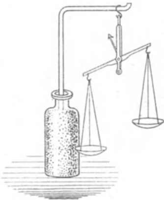
Fig. 138. Handwaage mit Stativ.
