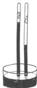
Fig. 56. Sichtbar- machen des Dampf- drucks.
