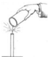
Fig. 33. Löschen einer Flamme durch Ausgießen von Kohlendioxyd.
