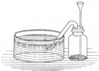
Fig. 224. Darstellung von Siliciumwasserstoff.
