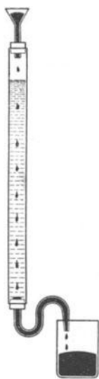
Fig. 238. Reinigung des Quecksilbers.
