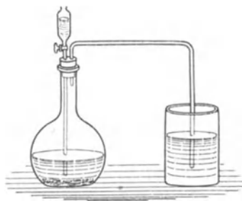
Fig. 210. Reduktion der schwefligen Säure zu Schwefelwasserstoff.
