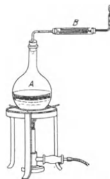
Fig. 52. Apparat zur Zersetzung von Wasserdampf durch Magnesium.
