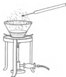
Fig. 37. Probe auf Siliciumverbindungen.
