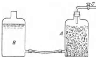
Fig. 152. Apparat zur Entwicklung von Gasen.
