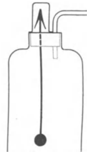
Fig. 217 b. Elektroskop. (Detailzeichnung zu Fig. 217 a).
