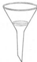
Fig. 143. Trichter mit eingesetzter Saugplatte.
