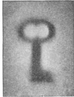
Fig. 244. Radiographie eines Schlüssels.
