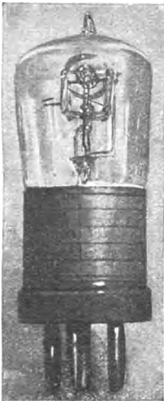
Abb. 100. Zweigitter-Elektrodenröhre von Siemens- & Halske.
