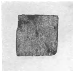
Fig. 12. Ätzung mit Kupferammoniumchlorid. Äußerer Rahmen: Flußeisen mit 0,01% P; innerer Kern: Flußeisen mit 0,28% P.
