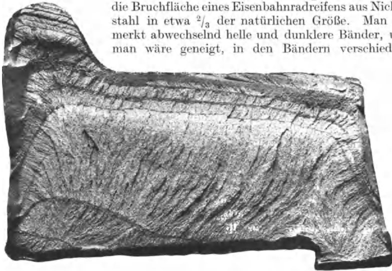
Fig. 27. Bruchfläche eines Eisenbahn-Radreifens.
