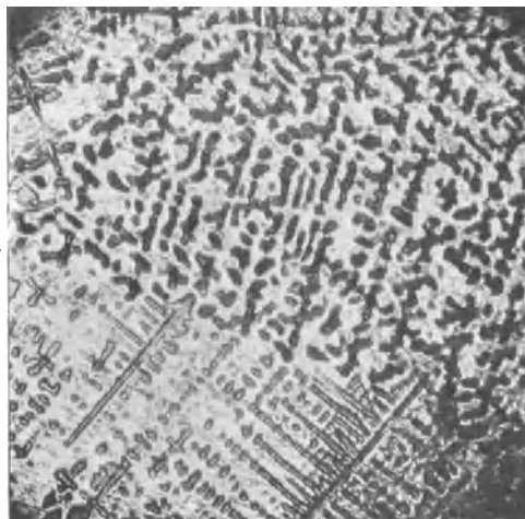
Fig. 34. Kleingefüge einer Bronze. (Vergrößerung 29fach.)
