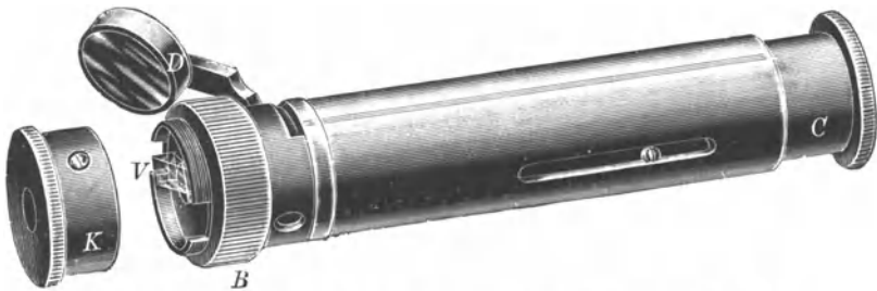
Fig. 3. Taschenspektroskop. Bauart Schmidt & Haensch, Berlin.
