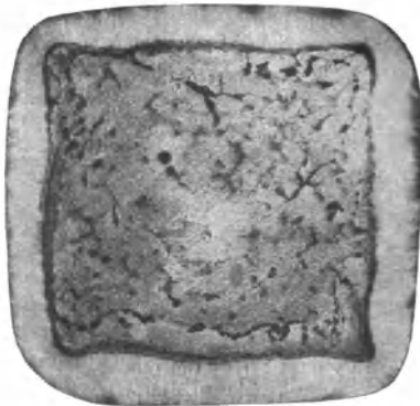
Fig. 18. Flußeisenknüppel. Querschliff am Kopfende.
