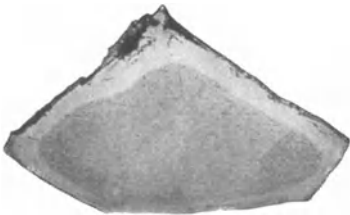
Fig. 14. Stahlstück an der Oberfläche entkohlht.
