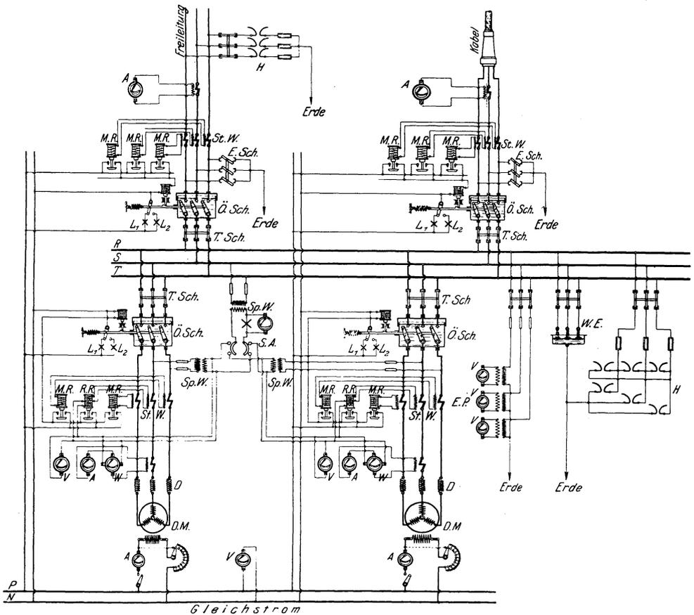
Fig. 293. Schaltung einer Hochspannungs-Drehstromzentrale (Ölschalter mit Relaisauslösung).
