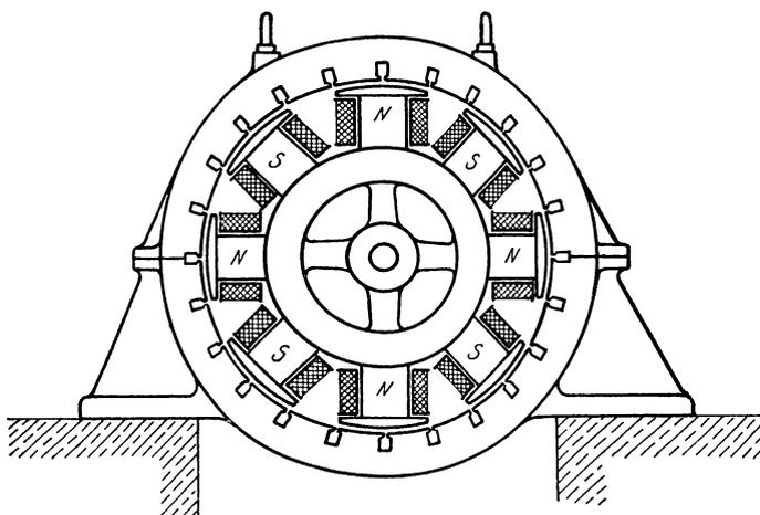
Fig. 147. Wechselstrom-Innenpolmaschine.
