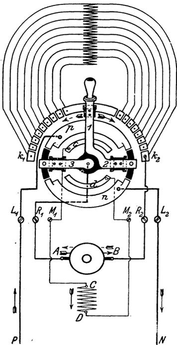
Fig. 137. Nebenschlußmotor mit Umkehranlasser.
