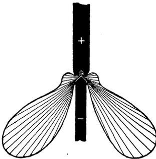
Fig. 235. Lichtverteilung eines Gleichstromlichtbogens.
