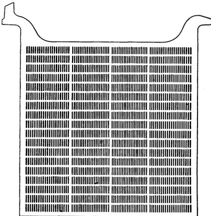
Fig. 224 a. Positive Platte eines Bleiakкумуляtors der Akкумуляtoren-Fabrik-Aktiengesellschaft.
