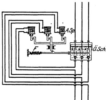
Fig. 261. Drehstromölschalter mit unmittelbarer primärer Maximalauslösung.
