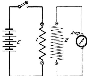
Fig. 35. Induktionswirkung zwischen zwei Spulen.
