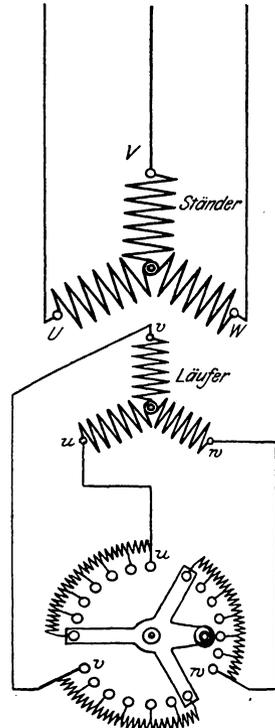
Fig. 197. Asynchroner Drehstrommotor mit Schleifringläufer nebst Anlasser.
