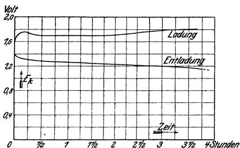
Fig. 234. Lade- und Entladespannung eines Edisonakkumulators.
