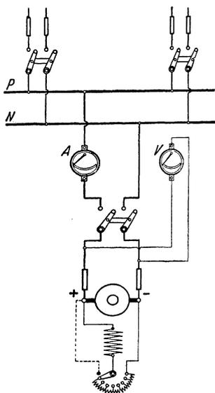
Fig. 278. Schaltung einer Gleichstromanlage mit einer Nebenschlußmaschine.
