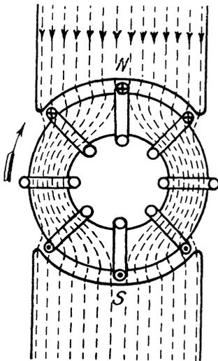
Fig. 80. Gleichstromanker mit einer Windung.
