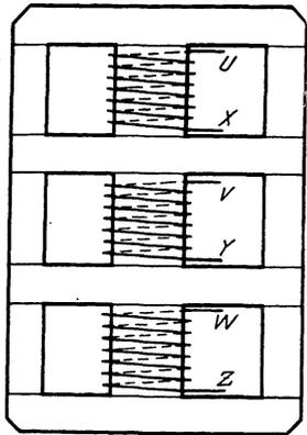
Fig. 175. Manteltransformator für Drehstrom.
