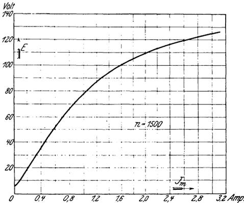
Fig. 108. Leerlaufcharakteristik einer Nebenschlußmaschine für 4 kW, 110 V, 36,5 A,  $n = 1500$ .
