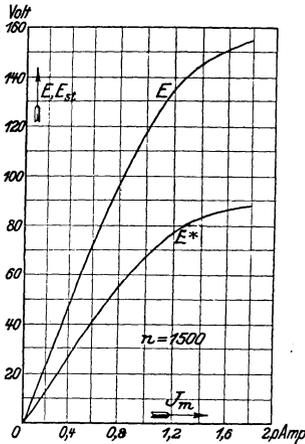
Fig. 159. Leerlaufcharakteristik einer Drehstrommaschine in Sternschaltung für 2,5 kVA, 120 V, 12 A,  $f = 50$ ,  $n = 1500$ .
