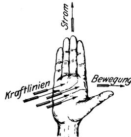
Fig. 34. Anwendung der Rechtehandregel.
