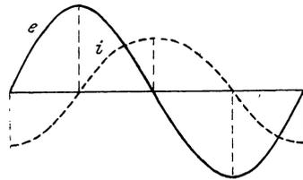
Fig. 41. Phasenverschiebung von  $90^\circ$ .
