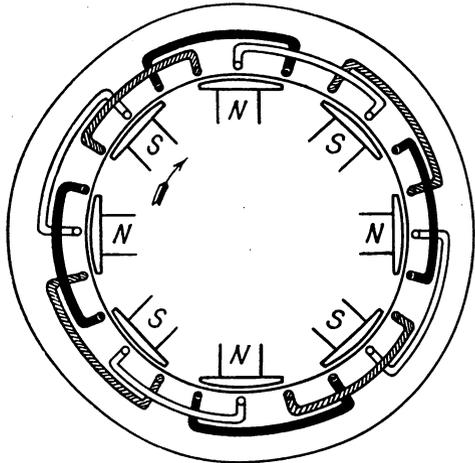
Fig. 151. Ankerwicklung einer Dreiphasenmaschine (eine Nute pro Pol und Phase).
