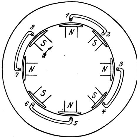
Fig. 149. Ankerwicklung einer Einphasenmaschine (eine Nute pro Pol).
