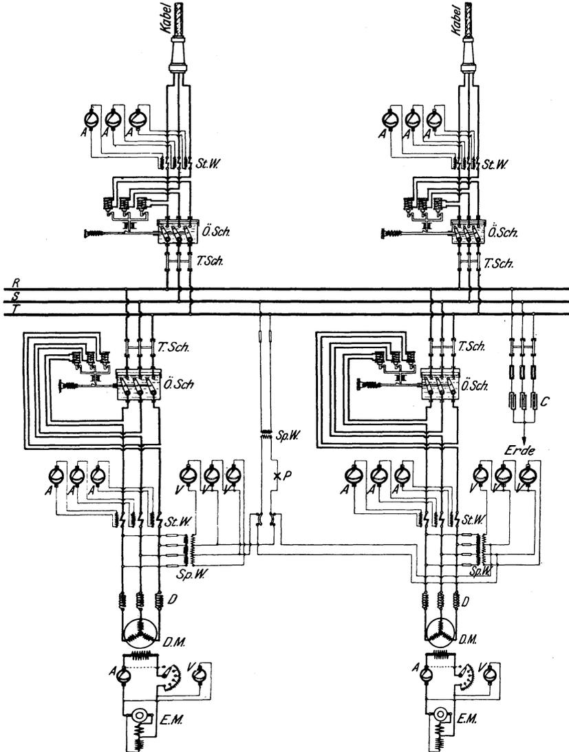
Fig. 292. Schaltung einer Hochspannungs-Drehstromzentrale (Ölschalter mit unmittelbarer Auslösung).
