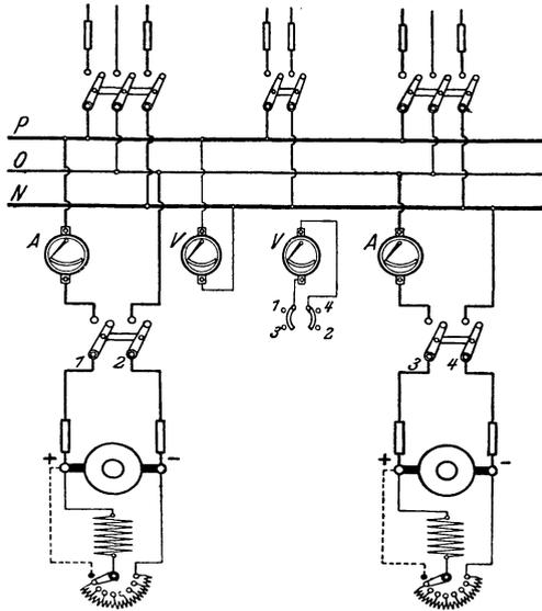
Fig. 284. Schaltung einer Gleichstromdreileiteranlage mit zwei hintereinander geschalteten Nebenschlußmaschinen.
