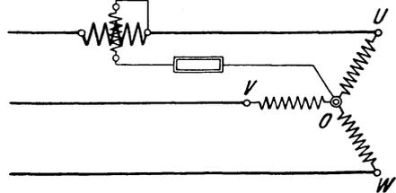
Fig. 72. Schaltung eines Wattmeters bei Drehstrom in Sternschaltung.
