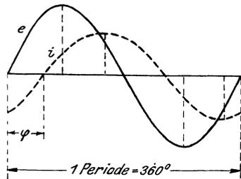
Fig. 39. Phasenverschiebung zwischen Spannung und Stromstärke eines Wechselstromes.
