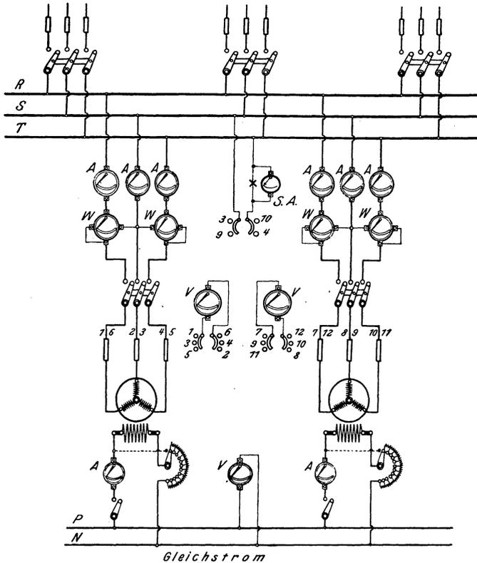
Fig. 291. Schaltung einer Drehstromanlage mit zwei Betriebsmaschinen.
