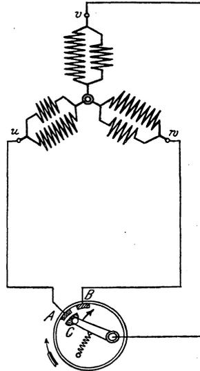
Fig. 200. Läufer eines Drehstrommotors mit Gegenschaltung.
