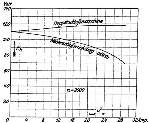
Fig. 115. Äußere Charakteristik einer Doppelschlußmaschine für 2,4 kW, 110 V 21,8 A,  $n = 2000$ .
