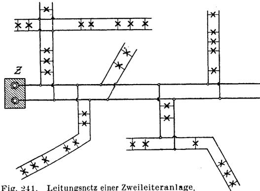
Fig. 241. Leitungsnetz einer Zweileiteranlage.
