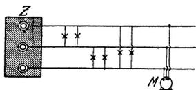
Fig. 248. Drehstromanlage ohne Nulleiter.
