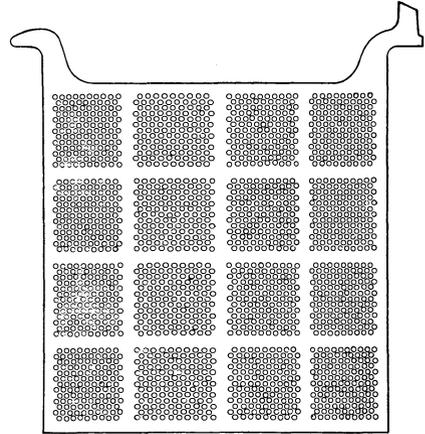
Fig. 224 b. Negative Platte eines Bleiakкумуляtors der Akкумуляtoren-Fabrik-Aktiengesellschaft.
