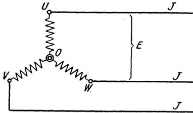
Fig. 51. Drehstrom in Sternschaltung mit drei Leitungen.
