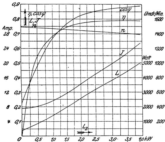
Fig. 201. Betriebskurven eines asynchronen Drehstrommotors mit Schleifringläufer für 3 kW (ca 4,1 PS), 120 V, 20 A,  $f = 50$ ,  $n = 1430$ .
