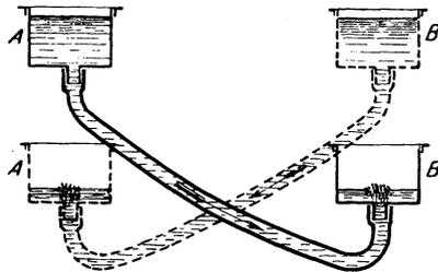
Fig. 36. Hervorrufung eines Flüssigkeitsstromes von wechselnder Richtung.
