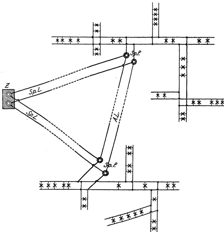
Fig. 242. Leitungsnetz einer Zweileiteranlage mit Spelseitungen.
