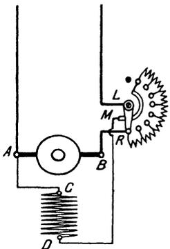
Fig. 129. Nebenschlußmotor mit Anlaßwiderstand mit Schiene.
