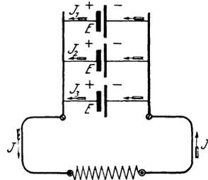
Fig. 14. Parallel geschaltete Elemente.
