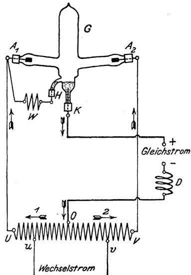
Fig. 213. Quecksilberdampfgleichrichter.
