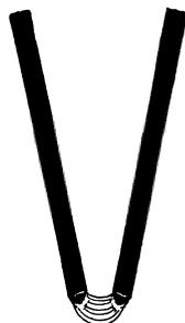
Fig. 240. Lichtbogen bei schräg nebeneinander angeordneten Kohlen.
