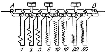
Fig. 3. Stöpselwiderstand für 100 Ω.
