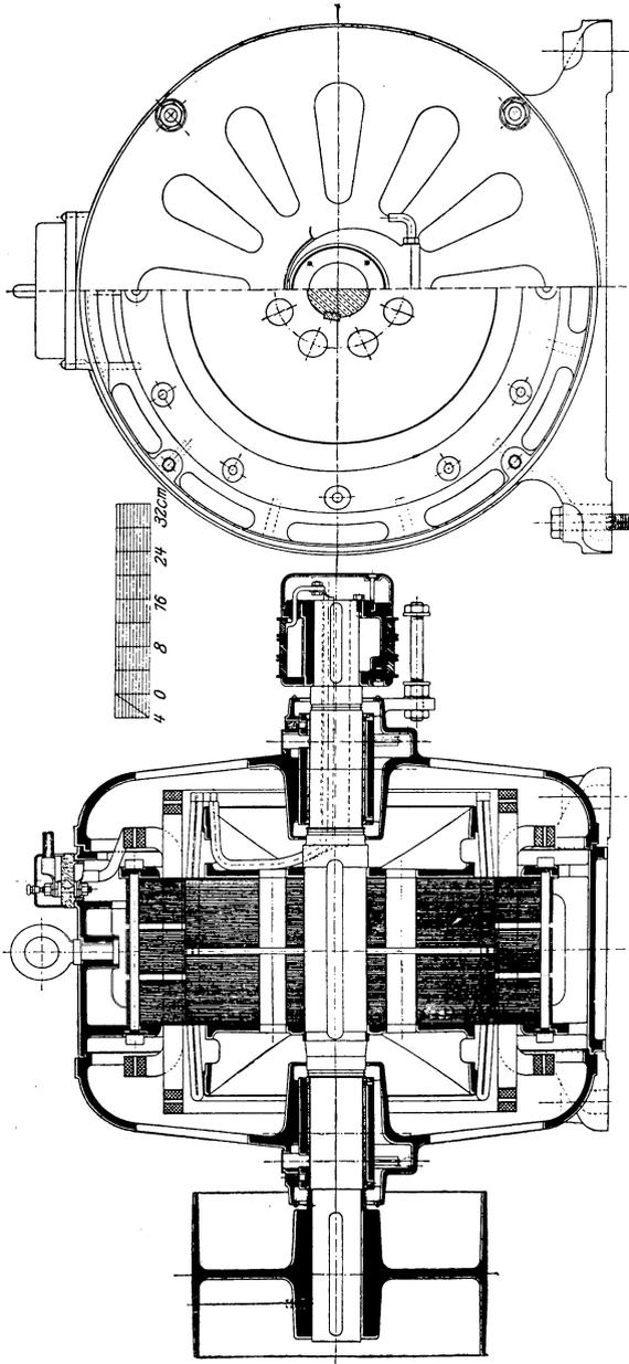
Fig. 198. Asynchroner Drehstrommotor mit Schleifringläufer der Siemens-Schuckertwerke für 39 kW (ca 41 PS), 500 V,  $f = 50$ ,  $n = 750$ .
