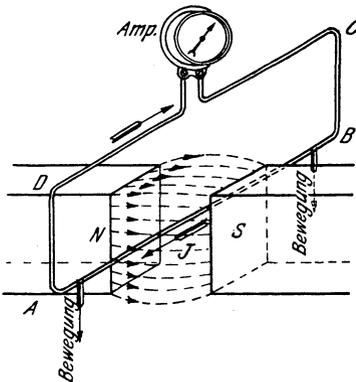
Fig. 33. Induktionswirkung durch Bewegung eines Leiters im magnetischen Felde.
