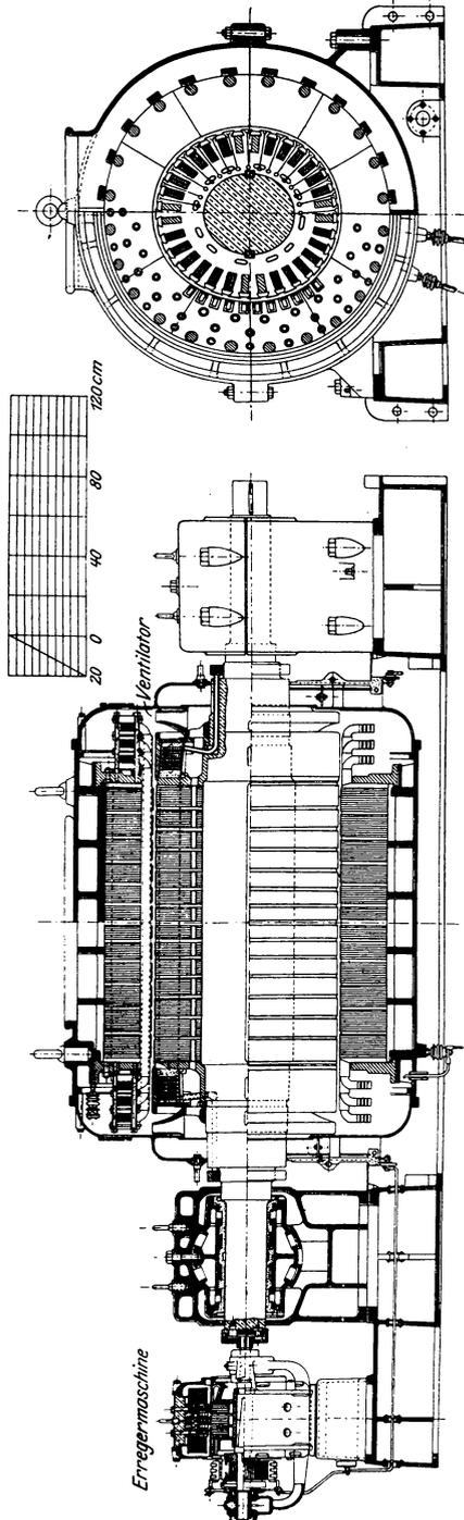
Fig. 158. Drehstromturbogenerator der Maschinenfabrik Oerlikon
