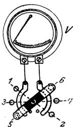
Fig. 257. Voltmeterumschalter.
