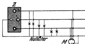
Fig. 249. Drehstromanlage mit Nulleiter.
