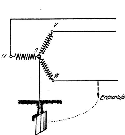
Fig. 276. Erdung des neutralen Punktes einer Drehstromanlage.
