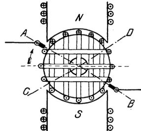
Fig. 102. Quer- und Gegenwindungen des Ankers.
