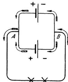
Fig. 86. Zwei parallel geschaltete Elemente.
