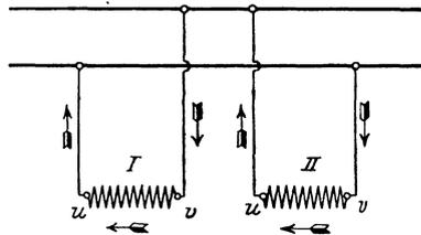
Fig. 184 b. Falscher Anschluß sekundär parallel zu schaltender Einphasentransformatoren.
