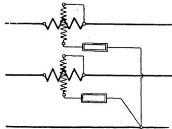
Fig. 75. Zweiwattmeterschaltung.
