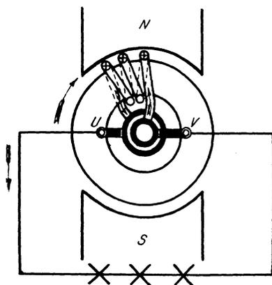
Fig. 81. Einspüliger Wechselstromanker.
