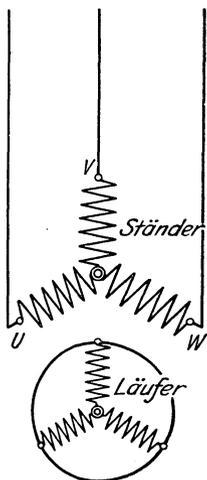
Fig. 196. Asynchroner Drehstrommotor mit Kurzschlußläufer.
