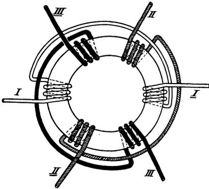
Fig. 191. Zweipoliger Ringanker für Dreiphasenstrom.
