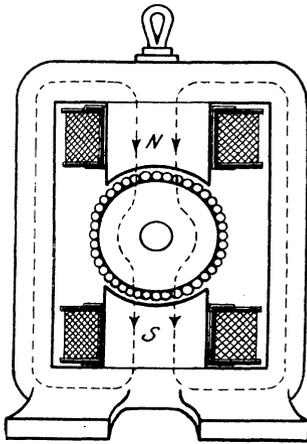
Fig. 96. Zweipolige Gleichstrommaschine.
