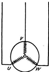
Fig. 154. Sternschaltung der Phasen einer Dreiphasenmaschine.
