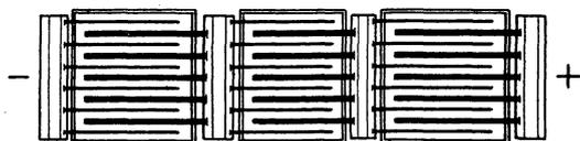
Fig. 227. Schaltung von Bleiakkumulatoren.
