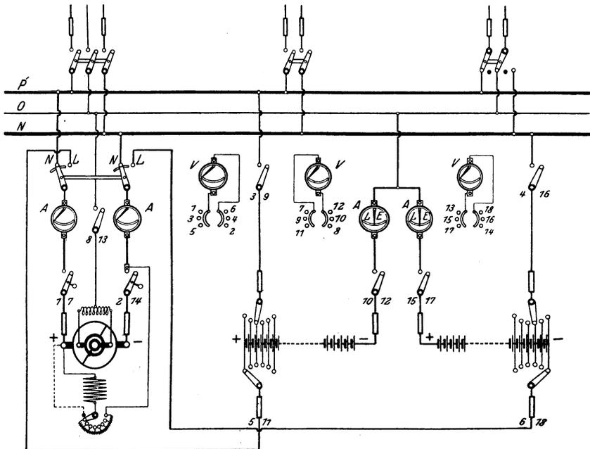
Fig. 288. Schaltung einer Gleichstromanlage mit einer Dreileitermaschine und einer Akkumulatorenbatterie.
