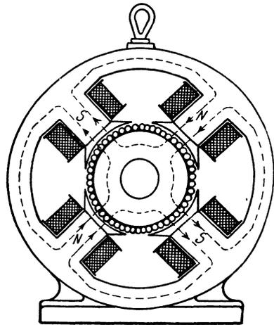
Fig. 97. Vierpolige Gleichstrommaschine.
