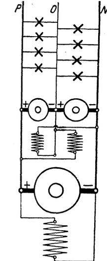
Fig. 246. Spannungsteilung durch Ausgleichsmaschinen mit kreuzweiser Erregung.
