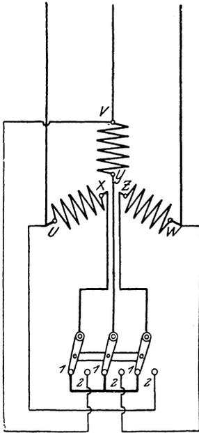
Fig. 199. Ständer eines Drehstrommotors mit Stern-Dreieck-Umschaltung.
