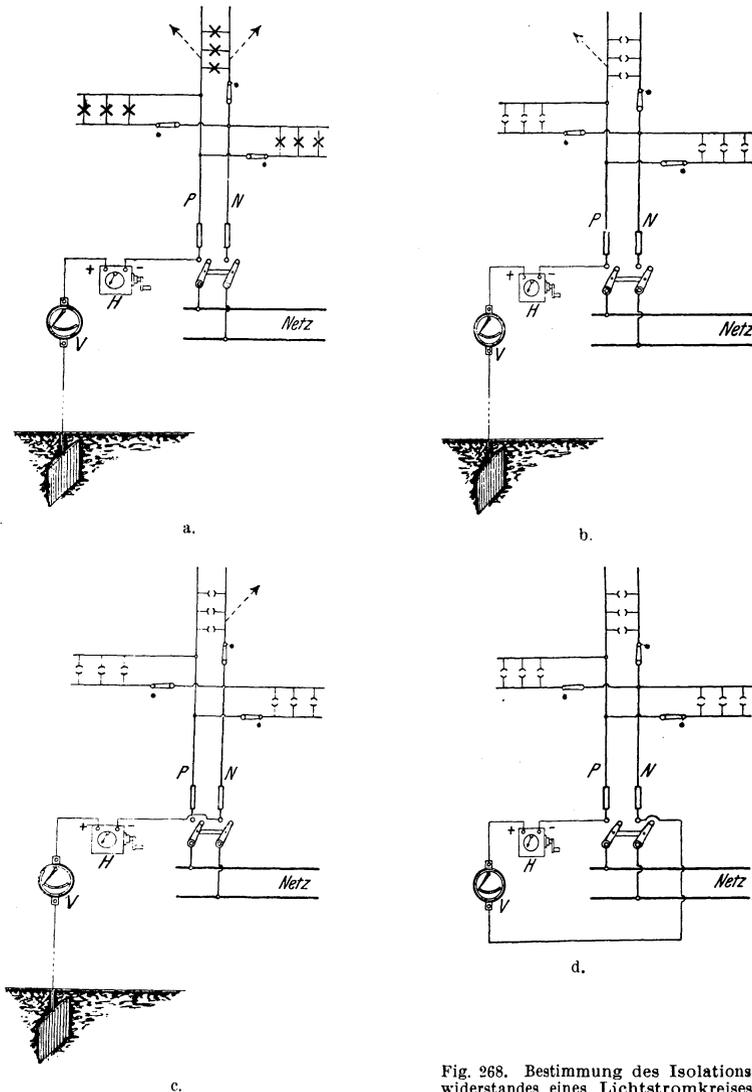
Fig. 268. Bestimmung des Isolationswiderstandes eines Lichtstromkreises.
