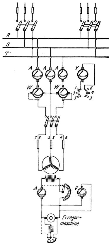
Fig. 290. Schaltung einer Drehstromanlage mit einer Betriebsmaschine.
