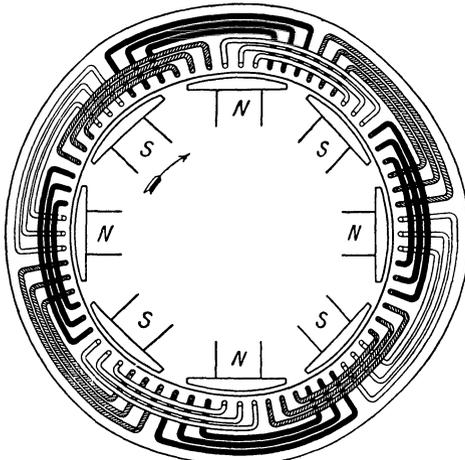
Fig. 153. Ankerwicklung einer Dreiphasenmaschine (drei Nuten pro Pol und Phase).
