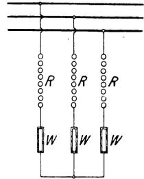
Fig. 273. Rollenableiter zwischen den Leitungen eines Drehstromnetzes.
