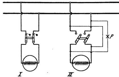
Fig. 167. Schaltung der Phasenlampe für Einphasenmaschinen (HELLSCHALTUNG).
