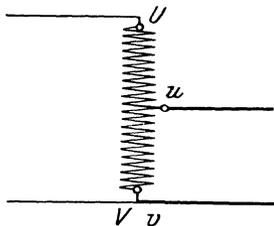
Fig. 180. Spartransformator für Einphasenstrom.
