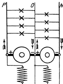
Fig. 243. Dreileiteranlage mit zwei hintereinander geschalteten Maschinen.
