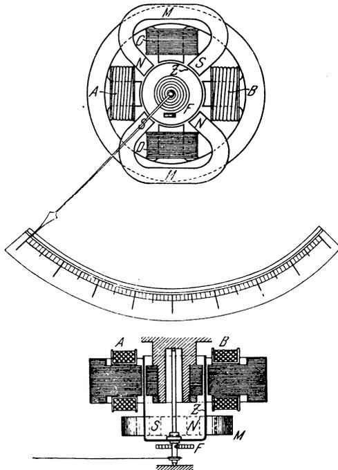
Fig. 62. Induktionsinstrument von Siemens & Halske.
