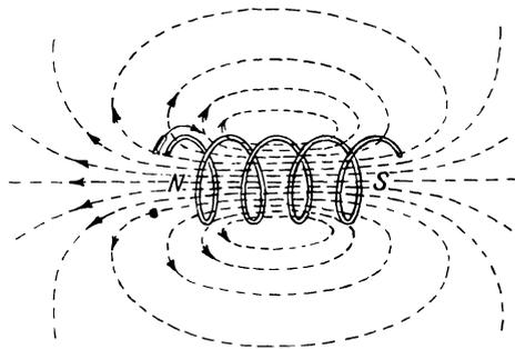
Fig. 26. Kraftlinien einer stromdurchflossenen Spule.
