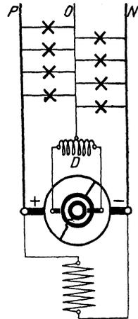
Fig. 247. Dreileitermaschine.
