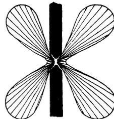
Fig. 236. Lichtverteilung eines Wechselstromlichtbogens.
