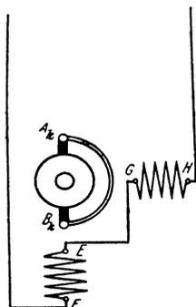
Fig. 206. Einphasen-kurzschlußmotor mit doppelter Felderregung.
