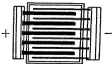
Fig. 225. Anordnung der Platten eines Bleiakkumulators.
