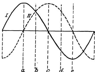
Fig. 189. Zweiphasenstrom.
