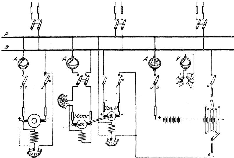
Fig. 283. Schaltung einer Gleichstromanlage mit einer Nebenschlußmaschine, einer Zusatzmaschine und einer Akkumulatorenbatterie mit Doppelzellenschalter.
