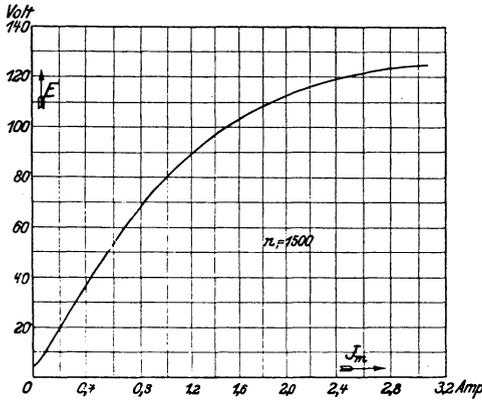
Fig. 104. Leerlaufcharakteristik einer fremderregten Maschine für 4 kW, 110 V, 36,5 A,  $n = 1500$ .
