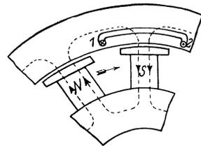
Fig. 161. Ankerrückwirkung einer Einphasenmaschine bei voreilem Strom.
