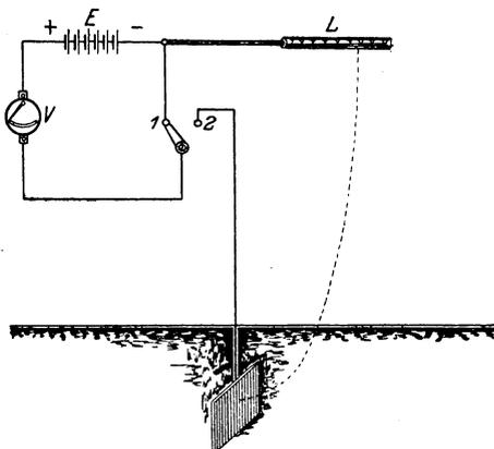
Fig. 266. Messung des Isolationswiderstandes einer Leitung gegen Erde.
