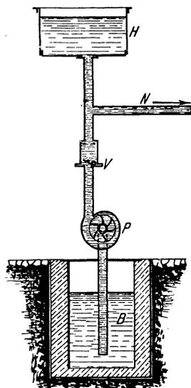
Fig. 223. Wasserwerk mit Hochbehälter als Ausgleichs- und Reserveorgan.
