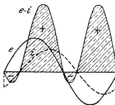
Fig. 43. Arbeit eines mit Phasenverschiebung behafteten Wechselstromes.
