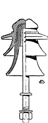
Fig. 252. Hochspannungs-Stützisolator.
