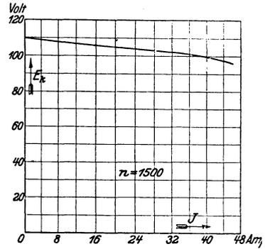
Fig. 105. Äußere Charakteristik einer fremderregten Maschine für 4 kW, 110 V, 36,5 A,  $n = 1500$ .
