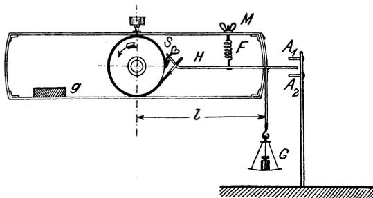
Fig. 222. Bremse nach Brauer.
