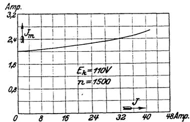
Fig. 110. Regulierungskurve einer Nebenschlußmaschine für 4 kW, 110 V, 36,5 A,  $n = 1500$ .
