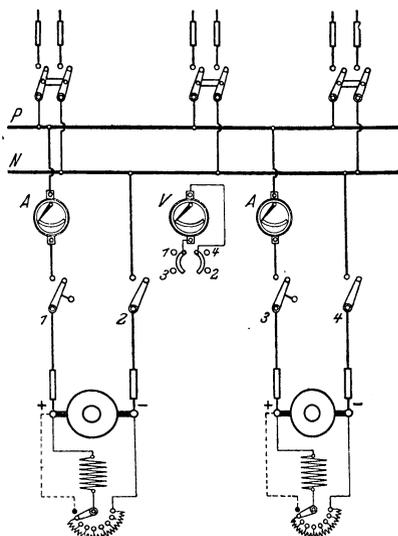
Fig. 279. Schaltung einer Gleichstromanlage mit zwei Nebenschlußmaschinen.
