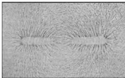
Fig. 18. Magnetisches Feld eines Stabmagneten.
