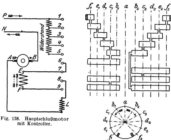
Fig. 138. Hauptschlußmotor mit Controller.
