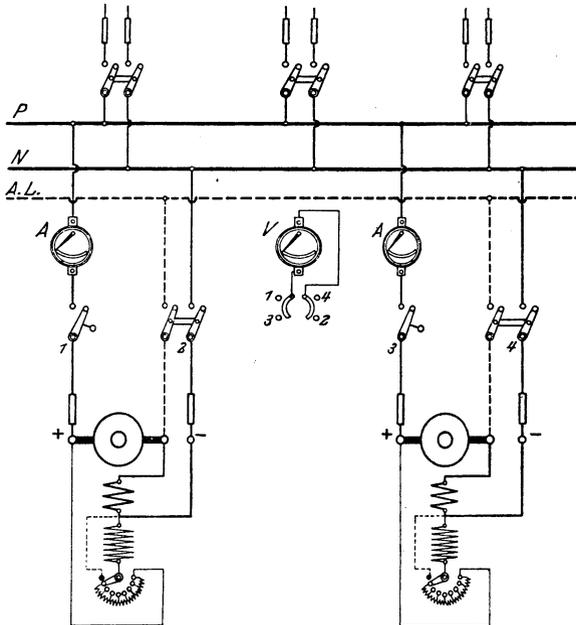
Fig. 280. Schaltung einer Gleichstromanlage mit zwei Doppelschlußmaschinen.
