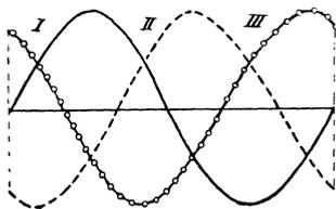
Fig. 48. Drehstrom.
