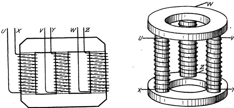
Fig. 173 und 174. Kerntransformatoren für Drehstrom.
