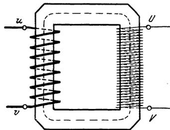
Fig. 169. Magnetischer Kreis eines Transformators.
