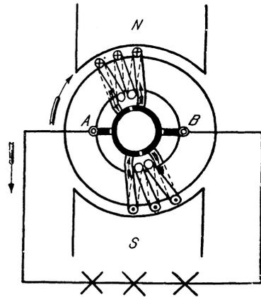
Fig. 84. Zweispoliger Gleichstromanker.
