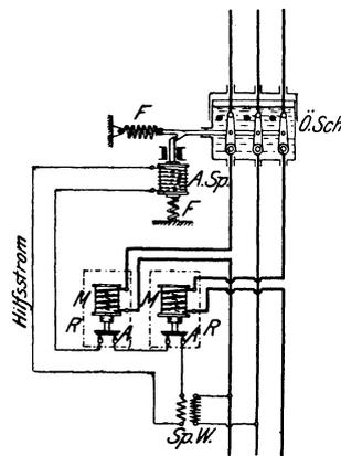
Fig. 263. Drehstromölschalter mit durch Relais betätigter primärer Maximalauslösung (Hilfsstrom: Wechselstrom).
