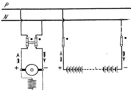
Fig. 230 a. Parallelbetrieb von Nebenschluß-
