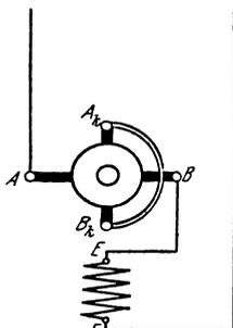
Fig. 207. Einphasen-hauptschluß-Kurzschlußmotor.
