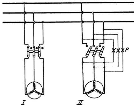
Fig. 168. Schaltung der Phasenlampen für Drehstrommaschinen (DUNKELSCHALTUNG).
