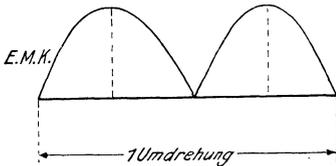
Fig. 83. EMK des einpoligen Gleichstromankers.
