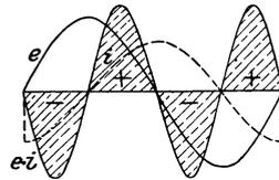
Fig. 44. Arbeit eines Wechselstromes mit  $90^\circ$  Phasenverschiebung.
