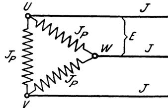
Fig. 52. Drehstrom in Dreieckschaltung.
