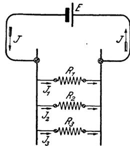
Fig. 11. Zwischen zwei Leitungen parallel geschaltet Widerstände.
