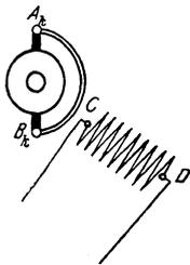
Fig. 205. Einphasen-kurzschlußmotor.
