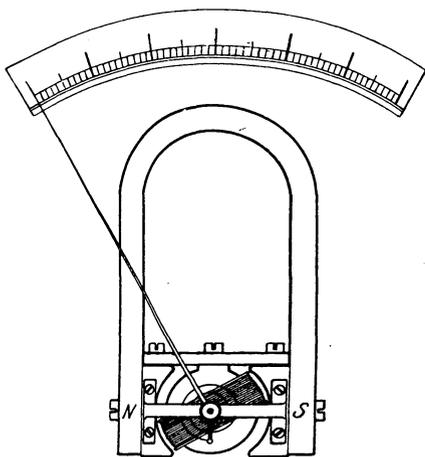
Fig. 57. Drehspulinstrument.
