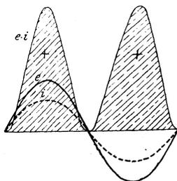
Fig. 42. Arbeit eines unverschobenen Wechselstromes.
