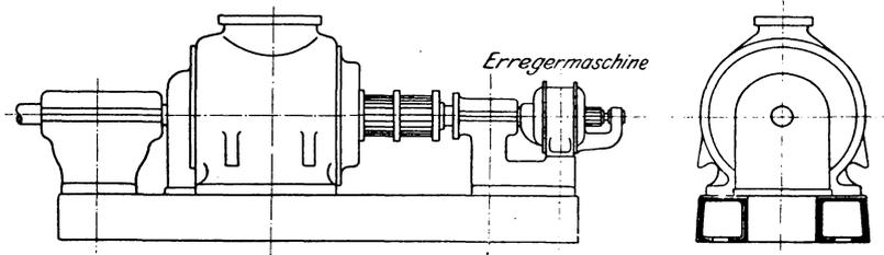
Fig. 118. Äußere Ansicht eines Gleichstromturbogenerators von Brown, Boveri & Co.
