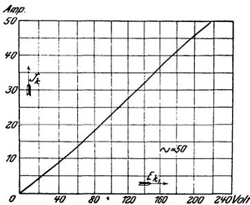
Fig. 177. Kurzschlußcharakteristik eines Einphasentransformators für 5 kVA, 120/3000 V, 44/1 A,  $f = 50$ .
