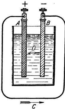
Fig. 2. Elektrischer Stromkreis.
