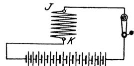
Fig. 127. Fremderregter Motor mit Anlaßwiderstand.
