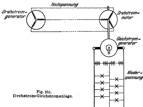
Fig. 251. Drehstrom-Gleichstromanlage.
