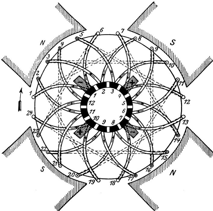
Fig. 92. Vierpoliger Trommelanker mit Parallelwicklung.
