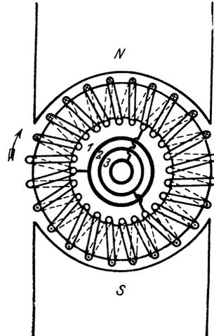
Fig. 146. Dreiphasenmaschine
