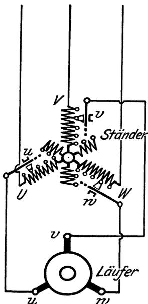
Fig. 211. Drehstromnebenschlusmotor mit Anzapfungen der Ständerwicklung.
