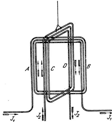
Fig. 29. Einwirkung zweier stromdurchflossener Spulen aufeinander.
