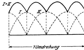
Fig. 88. EMK des vierspüligen Gleichstromankers.
