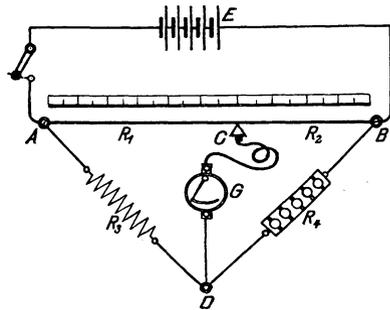
Fig. 67. Wheatstonesche Brücke mit Meßdraht.
