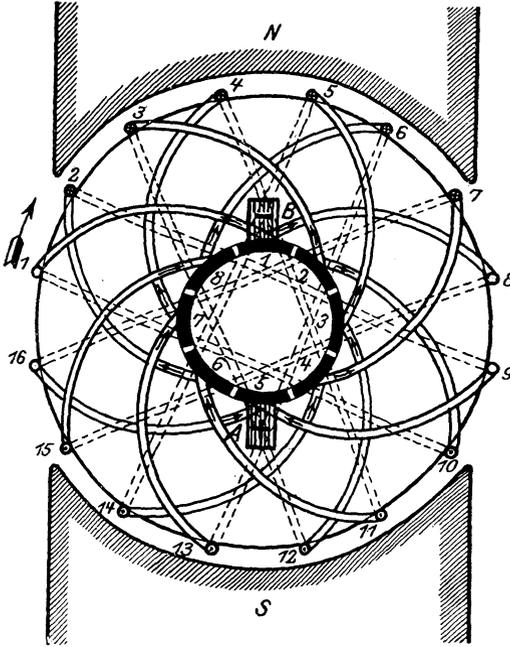
Fig. 91. Zweipoliger Trommelanker.
