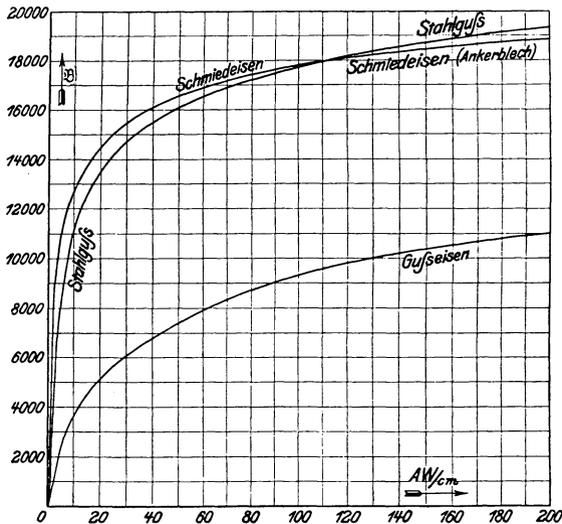
Fig. 31. Magnetisierungskurven der verschiedenen Eisenarten.
