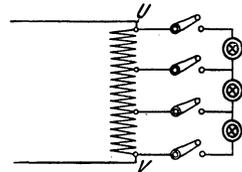
Fig. 181. Spannungsteiler.
