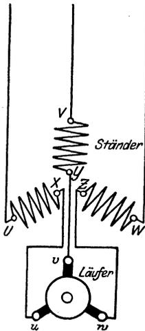
Fig. 209. Drehstromhauptschlußmotor.
