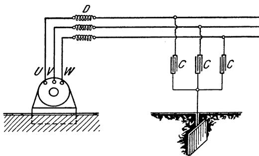
Fig. 275. Drehstromanlage mit Schutzkondensatoren und -drosselspulen.
