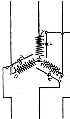
Fig. 183. Reguliertransformator in Sparschaltung für Drehstrom.
