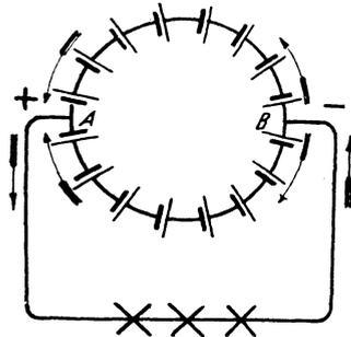
Fig. 90. Der Ringschaltung entsprechende Elementenschaltung.
