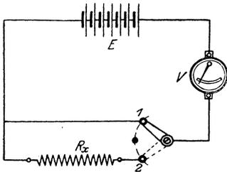
Fig. 69. Bestimmung des Widerstandes nach der Voltmetermethode.
