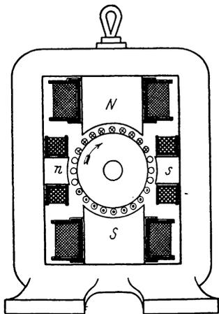
Fig. 116. Zweipolige Gleichstrommaschine mit Wendepolen.
