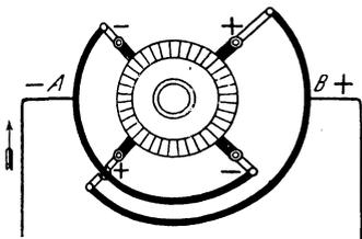
Fig. 93. Bürstenschaltung einer vierpoligen Maschine.
