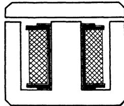
Fig. 28. Mantelförmiger Magnet.
