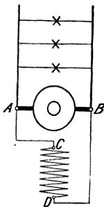
Fig. 107. Nebenschlußmaschine.
