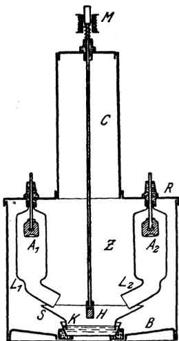
Fig. 214. Quecksilberdampfgleichrichter mit Eisengehäuse (Großgleichrichter).
