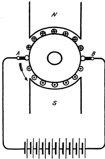
Fig. 125. Zweipoliger Gleichstrommotor.
