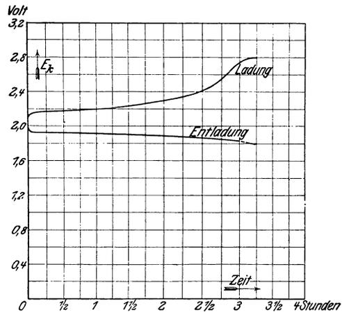
Fig. 226. Lade- und Entladespannung eines Bleiakkumulators.
