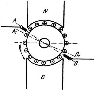
Fig. 126. Bürstenverschiebung eines Gleichstrommotors.
