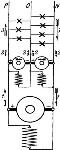
Fig. 245. Spannungsteilung durch Ausgleichsmaschinen mit eigener Erregung.
