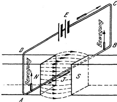
Fig. 24. Einwirkung eines Magneten auf einen stromdurchflossenen Leiter.
