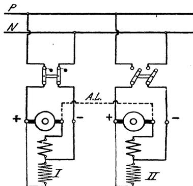
Fig. 124. Parallelbetrieb zweier Doppelschlußmaschinen.
