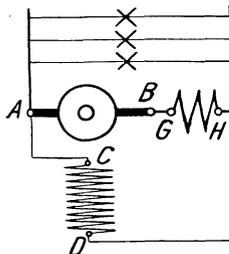
Fig. 117. Nebenschlußmaschine mit Wendepolen.
