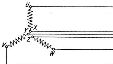
Fig. 49. Drehstrom mit sechs Leitungen.
