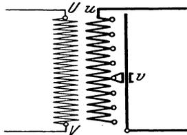
Fig. 182. Reguliertransformator für Einphasenstrom.
