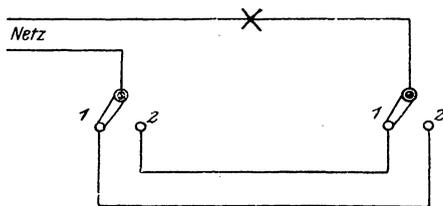
Fig. 258. Wechselschaltung.
