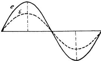
Fig. 40. Phasenverschiebung null.
