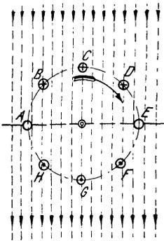
Fig. 37. Hervorrufung eines Wechselstromes.
