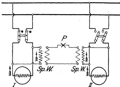
Fig. 179. Schaltung einer Phasenlampe bei Hochspannungs-Wechselstrommaschinen.
