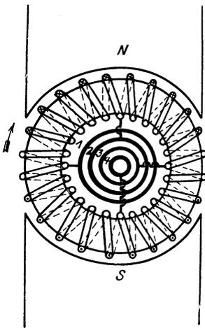
Fig. 145. Zweiphasenmaschine
