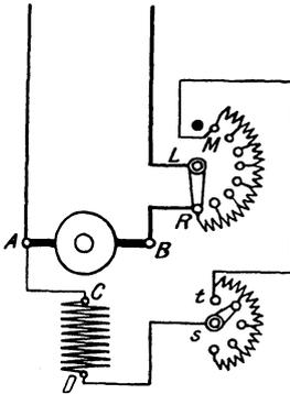
Fig. 133. Nebenschlußmotor mit Anlaufwiderstand und Tourenregler.
