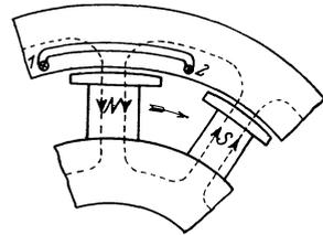
Fig. 160. Ankerrückwirkung einer Einphasenmaschine bei verzögertem Strom.
