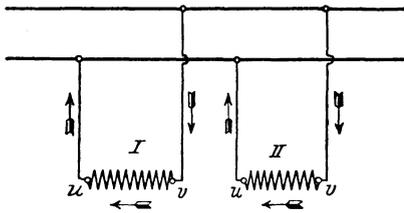
Fig. 184 a. Richtiger Anschluß sekundär parallel zu schaltender Einphasentransformatoren.
