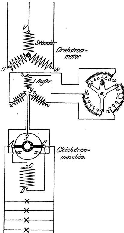
Fig. 212. Kaskadenumformer.
