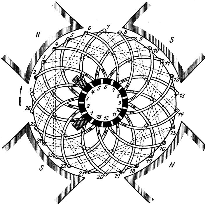
Fig. 94. Vierpoliger Trommelanker mit Reihenwicklung.
