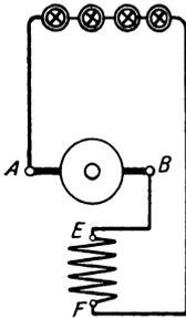
Fig. 112. Hauptschlußmaschine.
