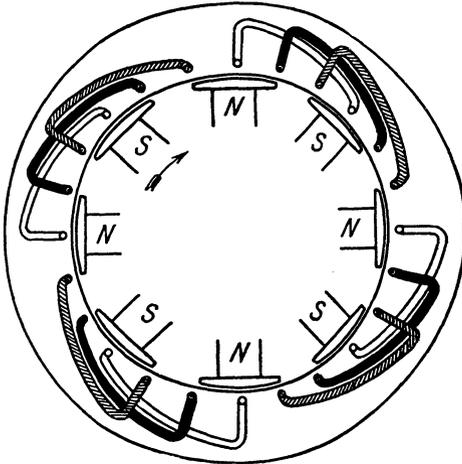
Fig. 152. Ankerwicklung einer Dreiphasenmaschine für zweiteilige Anker (eine Nute pro Pol und Phase).
