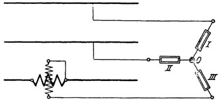
Fig. 74. Schaltung eines Wattmeters bei Drehstrom mit künstlichem Nullpunkt.
