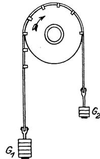
Fig. 221. Bandbremse.
