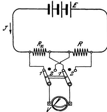
Fig. 68. Widerstandsmessung nach der Vergleichsmethode.
