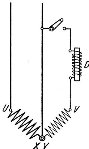
Fig. 202. Ständer eines asynchronen Einphasenmotors mit Hilfsphase.
