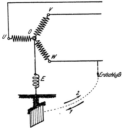
Fig. 277. Erdschlußspule in einer Drehstromanlage.
