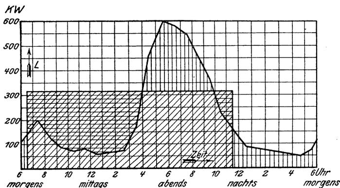
Fig. 232. Belastungskurve eines Elektrizitätswerkes.
