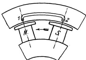
Fig. 185. Synchronmotor für Einphasenstrom.
