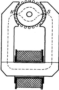
Fig. 79. Magnetischer Kreis einer Gleichstrommaschine.
