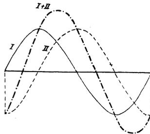
Fig. 45. Zweiphasenstrom.
