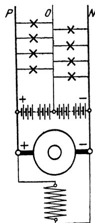
Fig. 244. Spannungsteilung durch eine Akkumulatorenbatterie.
