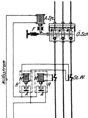
Fig. 262. Drehstromölschalter mit durch Relais betätigter sekundärer Maximalauslösung (Hilfsstrom: Gleichstrom).
