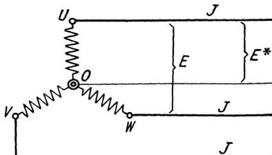
Fig. 50. Drehstrom in Sternschaltung mit Nulleiter.
