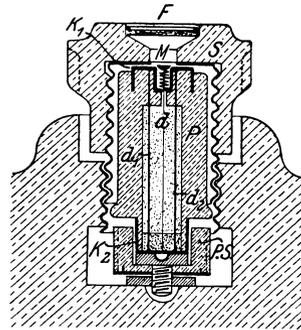
Fig. 265. Schnitt durch eine zweiteilige Edisonsicherung.
