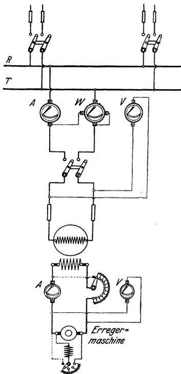
Fig. 289. Schaltung einer Einphasenanlage mit einer Betriebsmaschine.
