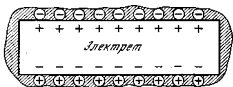
Рис. 50. Экранирование зарядов электрета ионами водяной пленки
