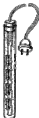
Аквариумный нагреватель из остеклованных сопротивлений.
