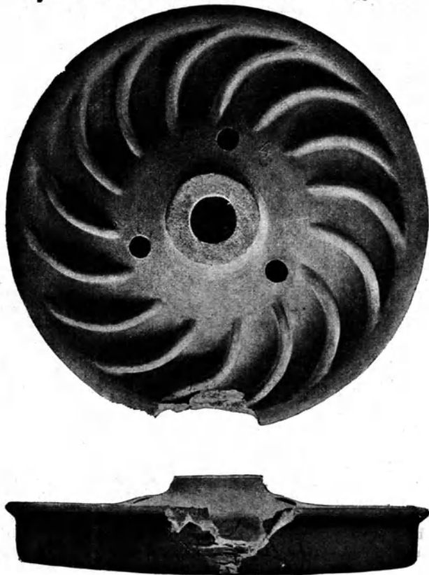
Fig. 28 und 29. Griffin-Rad nach der Schlagprobe.
